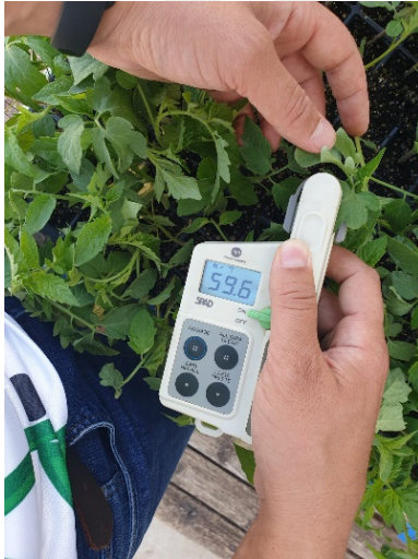
Şekil 3.3. SPAD502 Plus cihazıyla yapraktan klorofil ölçümü
