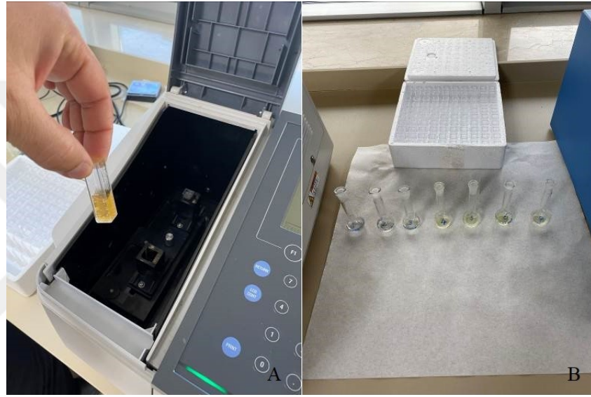
Şekil 3.4. A) MDA ve H 2 O 2 ölçümleri için kullanılan spektrofotometre B) H 2 O 2 ölçümü için kullanılan standartlar
