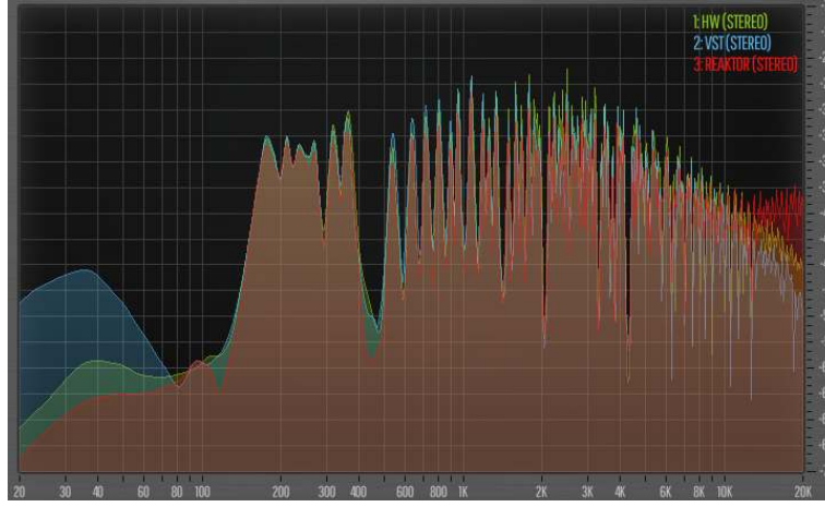
Şekil 4.4 MS-20 donanım ve VST'lerden elde edilen seslerin spektrum analizleri karşılaştırılması
