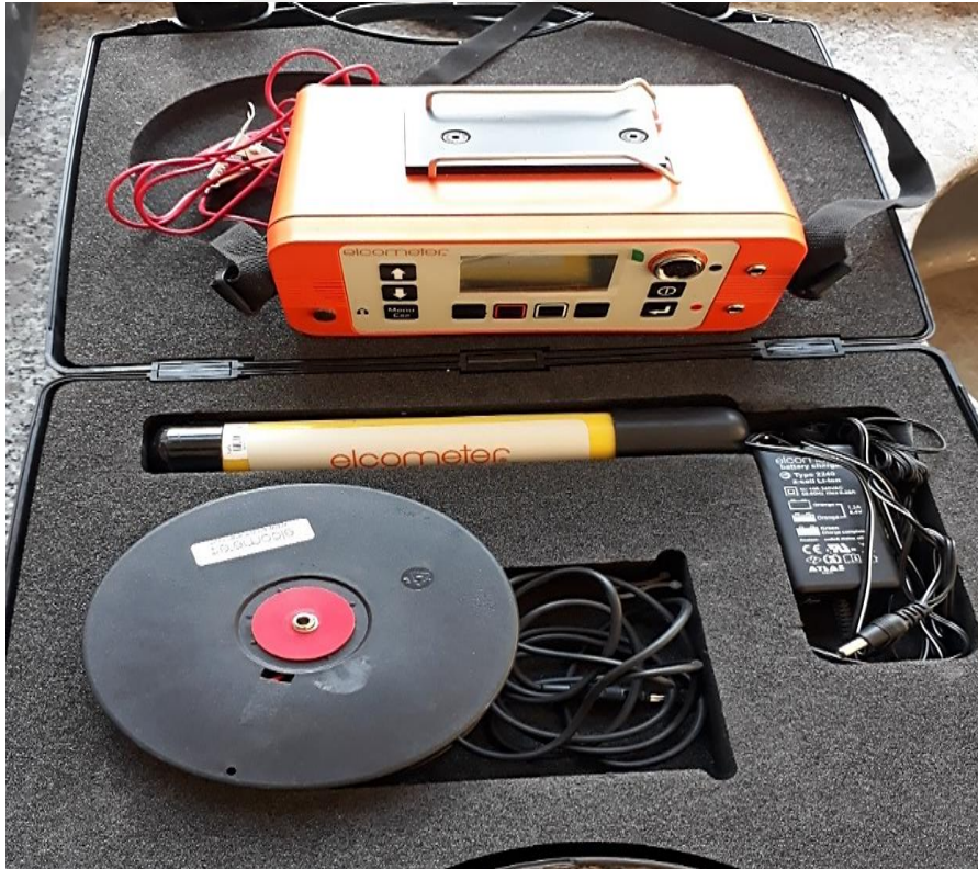
Resim 4.7 Yarı hücre potansiyeli deney cihazı
