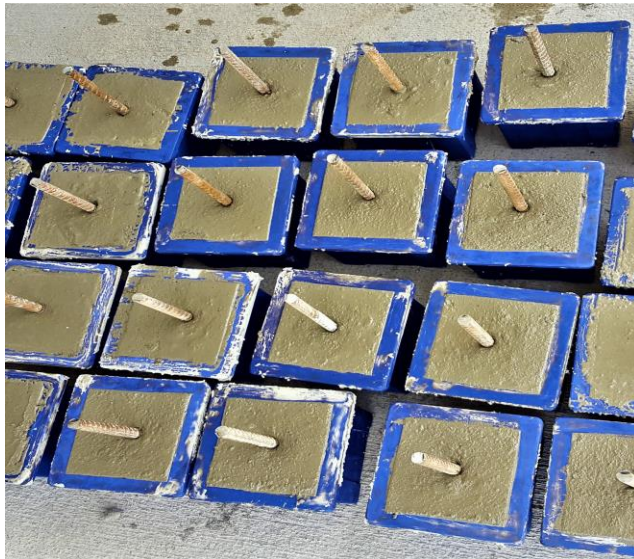
Resim 4.4 Betona gömülü çelik donatı
