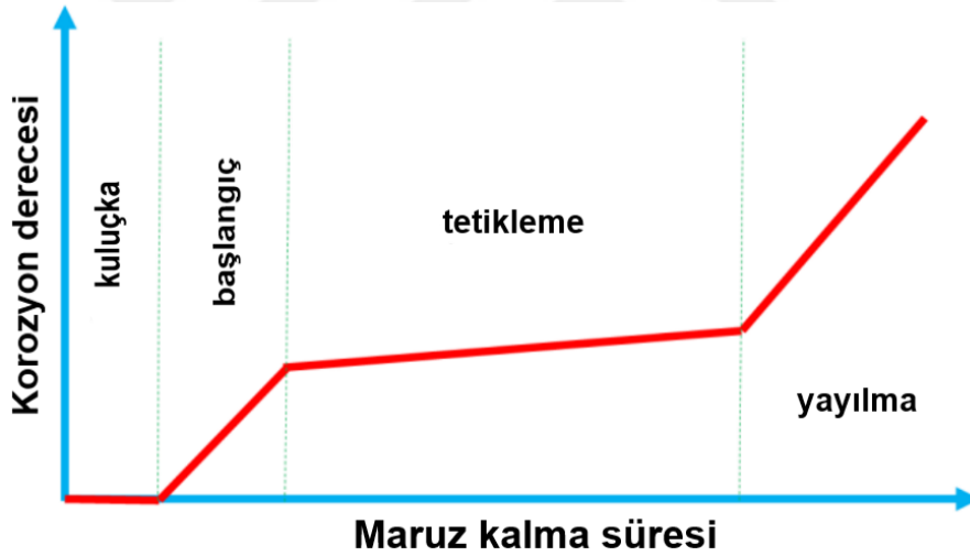
Şekil 2.1 Donatı korozyonu evrimi [1]
