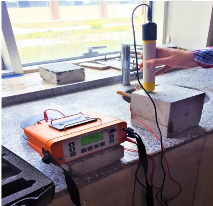
Resim 4.9 Numunenin yarı hücre potansiyeli ölçümü
