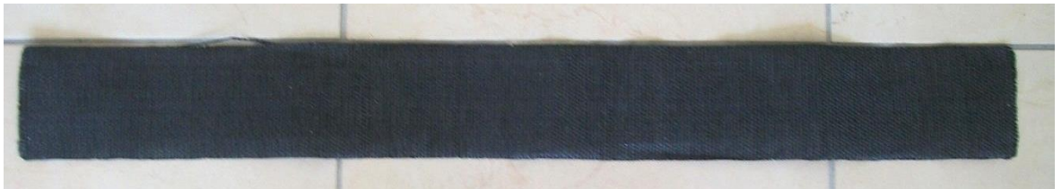
Şekil 2.8. Deneylerde kullanılan 100 x 900 mm boyutlarında kesilmiş örgülü geotekstil
