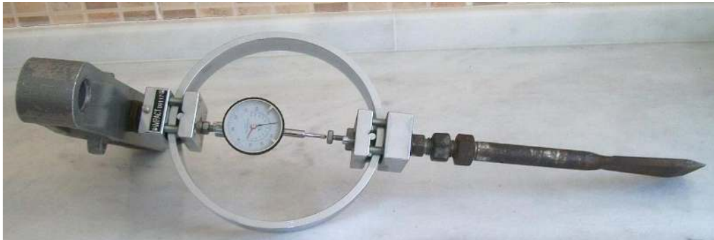
Şekil 2.10. Çalışmalarda kullanılan yük halkası ve yüklemeye bıçağı
