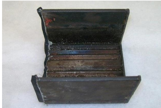
Şekil 2.3. Deneylerde kullanılan model şerit temel
