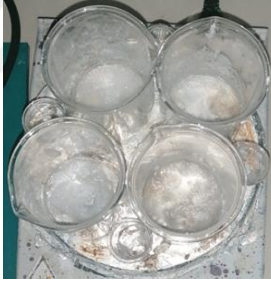
Şekil 2.9. Çözücü döküm ve parçacık uzaklaştırma yöntemi ile suda bekletilen numuneler.
