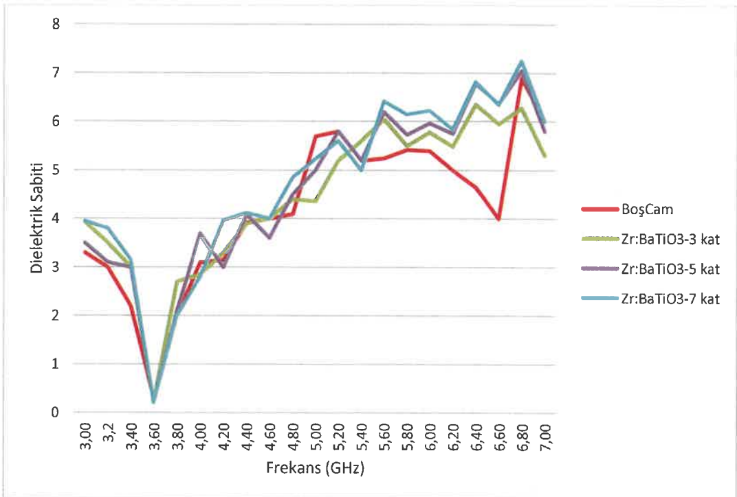
Şekil 4.36. Farklı sayıda kaplanmış Zr:BaTiO 3 ince filmlerin ısıtılma işlemi sonrası dielektrik sabitlerinin frekansla değişimi
