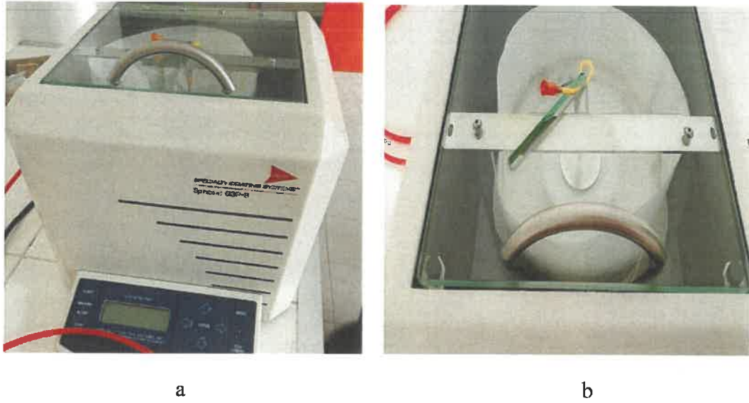
Şekil 3.2. Döndürerek kaplama a) cihazı ve b) kaplama haznesi
