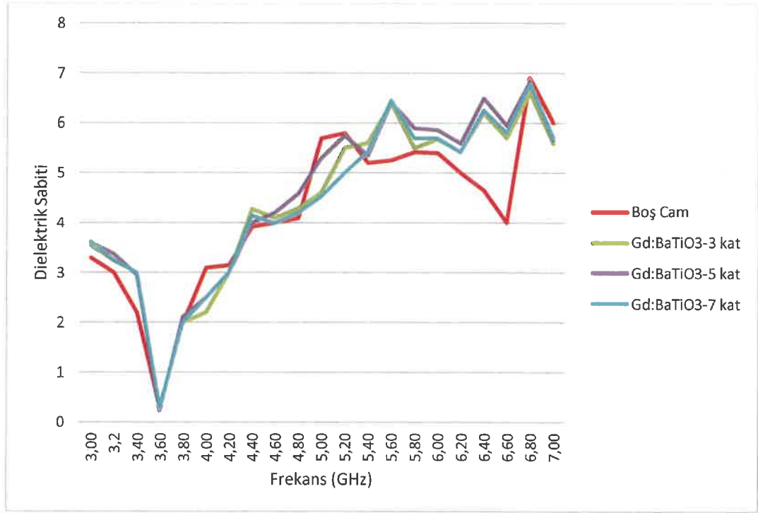
Şekil 4.33. Farklı sayıda kaplanmış Gd:BaTiO 3 ince filmlerin ısıtılma işlemi sonrası dielektrik sabitlerinin frekansla değişimi
