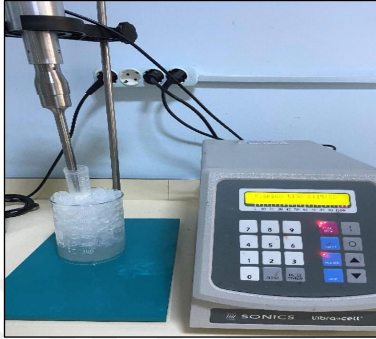
Şekil 9. Ultrasonikatör yardımıyla nanoemülsiyon eldesi
