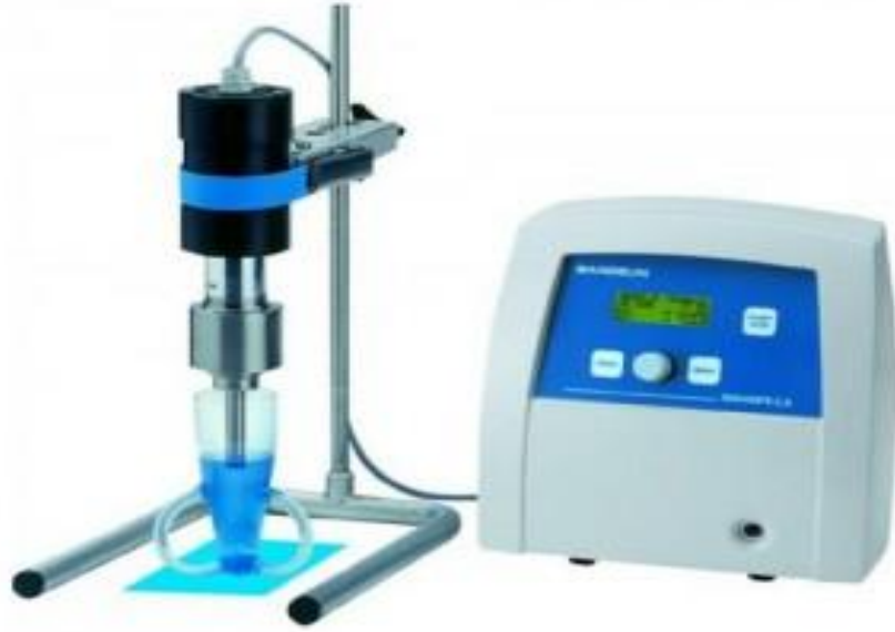
Şekil 3.1. Ultrasonikasyon cihazı (Sonoplus HD 3200 Bandelin, Almanya)
