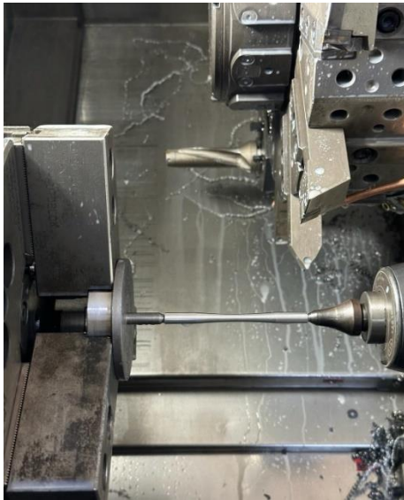
Şekil 25. Yorulma deney numunelerinin CNC Torna tezgahında işlenmesi
