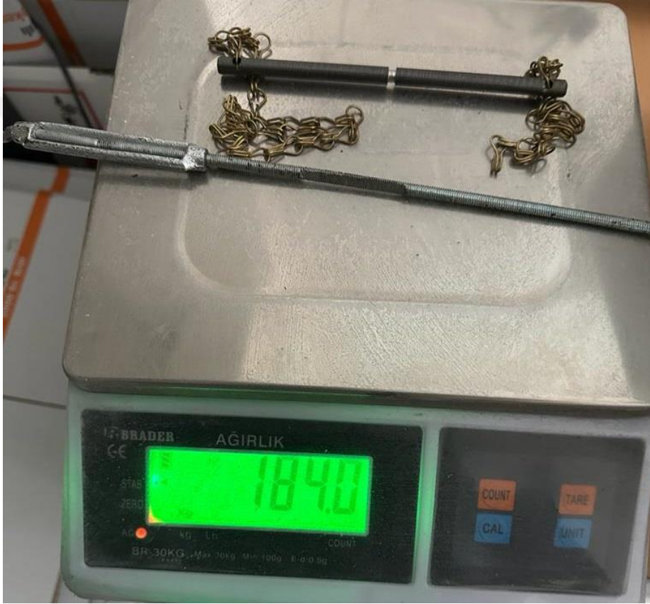
Şekil 23. Ağırlık sistemi mekanizmasının hassas terazi ile ölçümü
