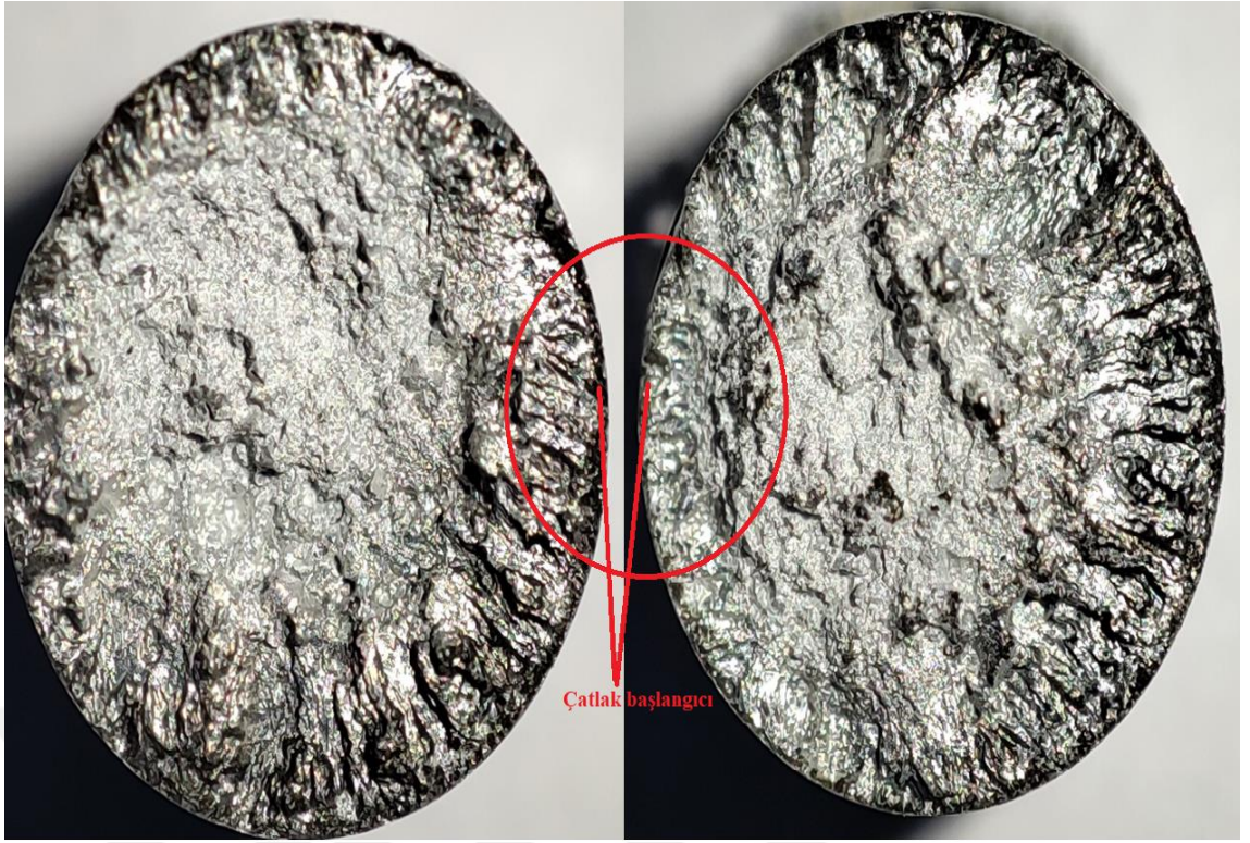
Şekil 29. AA 6063 Alüminyum Alaşımının yorulma hasarı yüzey görüntüsü
