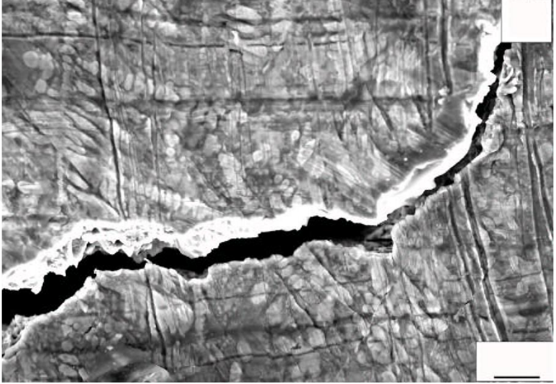
Şekil 13. Mikro çatlakların ve makro çatlakların oluşumunu gösteren SEM görüntüsü (Zhang ve Ark., 2007).
