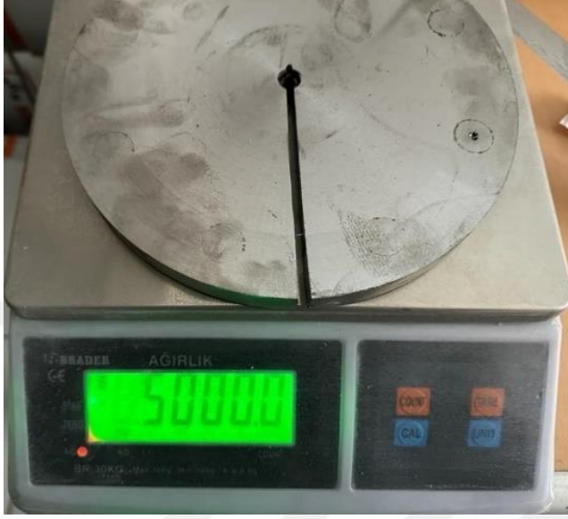
Şekil 19. Ağırlıkların hassas terazide tartılması
