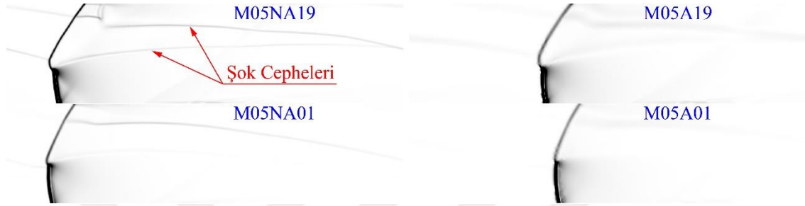
Şekil 5.5. Patlama kanalında patlama dalgası, eğik şok ve şok cepheleri
