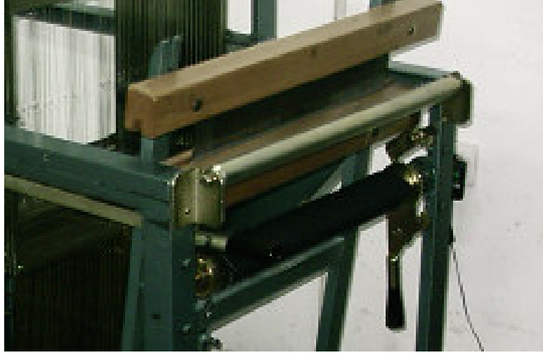
Şekil 57 Armürlü dokuma tezgâhının çözgü boşaltma ve kumaş sarma tertibatı
