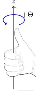
Şekil 3.6. Sağ el kuralı kullanılarak bir eksen etrafındaki pozitif dönüşlerin yönü
