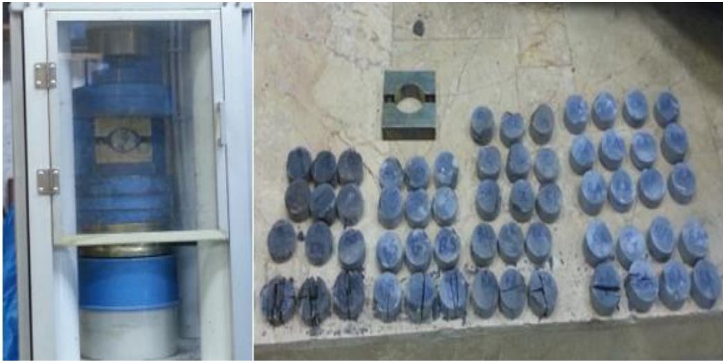
Şekil 4. Kaya örneklerinin BÇD R deneyi
