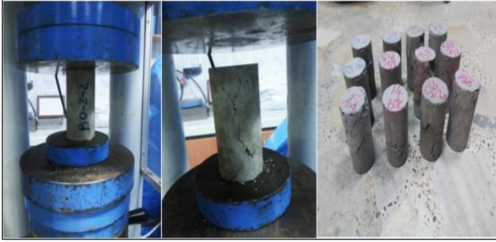
Şekil 13. Beton örneklerinin UCS c deneyi
