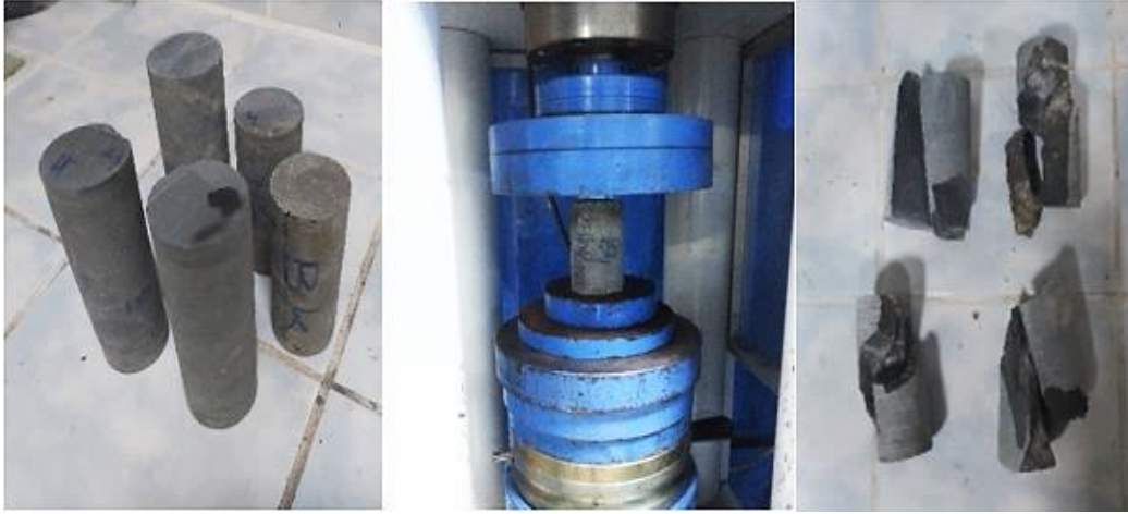
Şekil 3. Kaya örneklerinin UCS R deneyi
