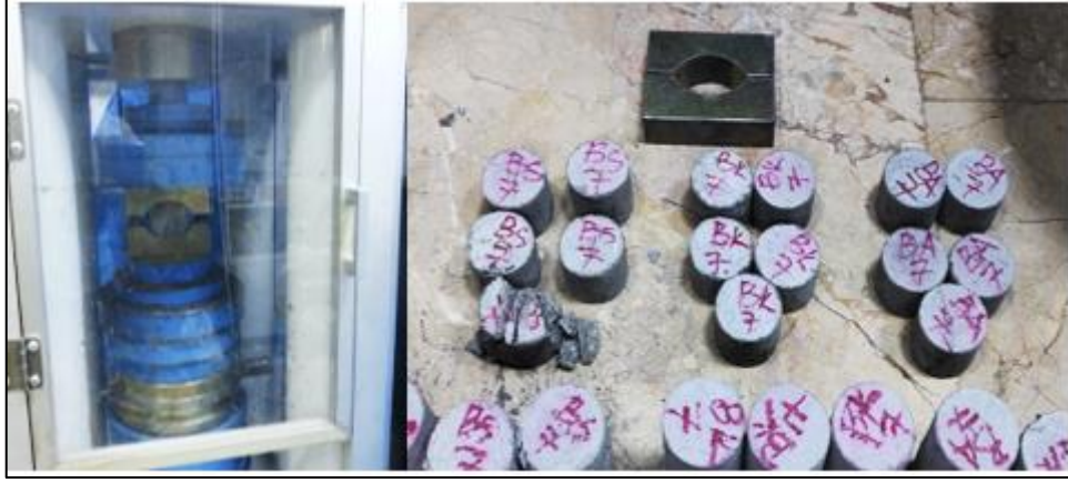
Şekil 14. Beton örneklerinin BCDc deneyi
