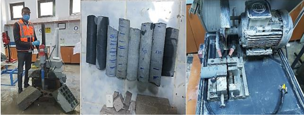
Şekil 2. Kaya örneklerinin hazırlanması
