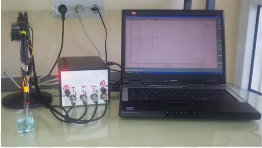
Şekil 2.8. Bilgisayar kontrollü potansiyometrik ölçüm sistemi
