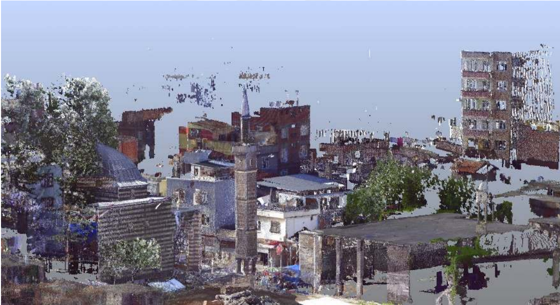
Şekil 4.9. Lazer taramadan elde edilen ham nokta bulutu görüntüsü.
