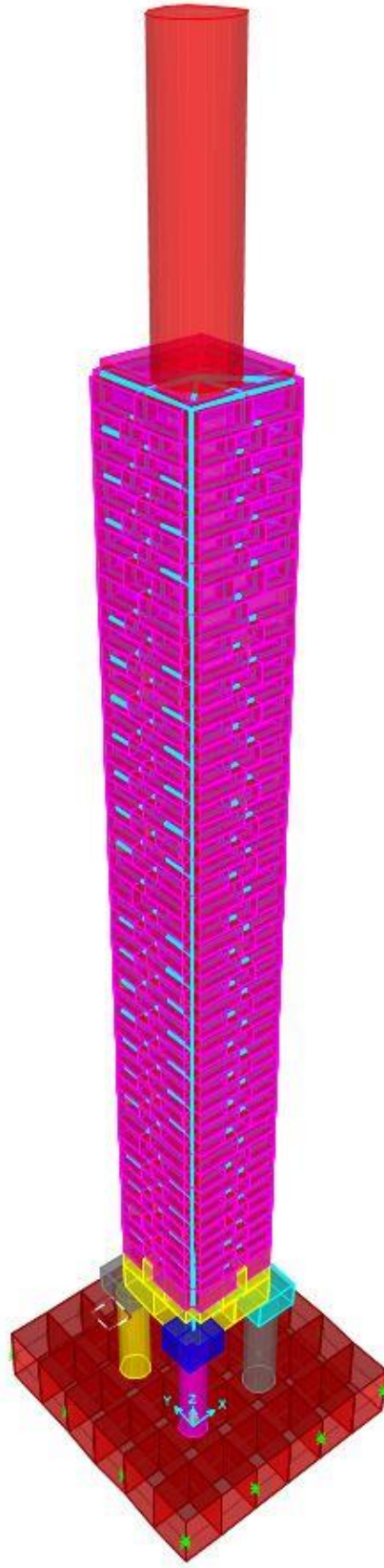
Şekil 4.41. Ticari program SAP2000’de oluşturulan minarenin geometrik modeli
