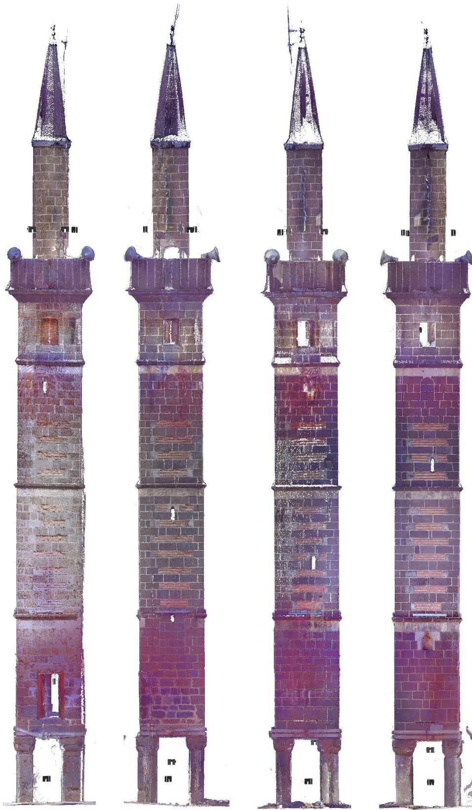
Şekil 4.11. Ham nokta bulutundan elde edilen minare kesitleri.
