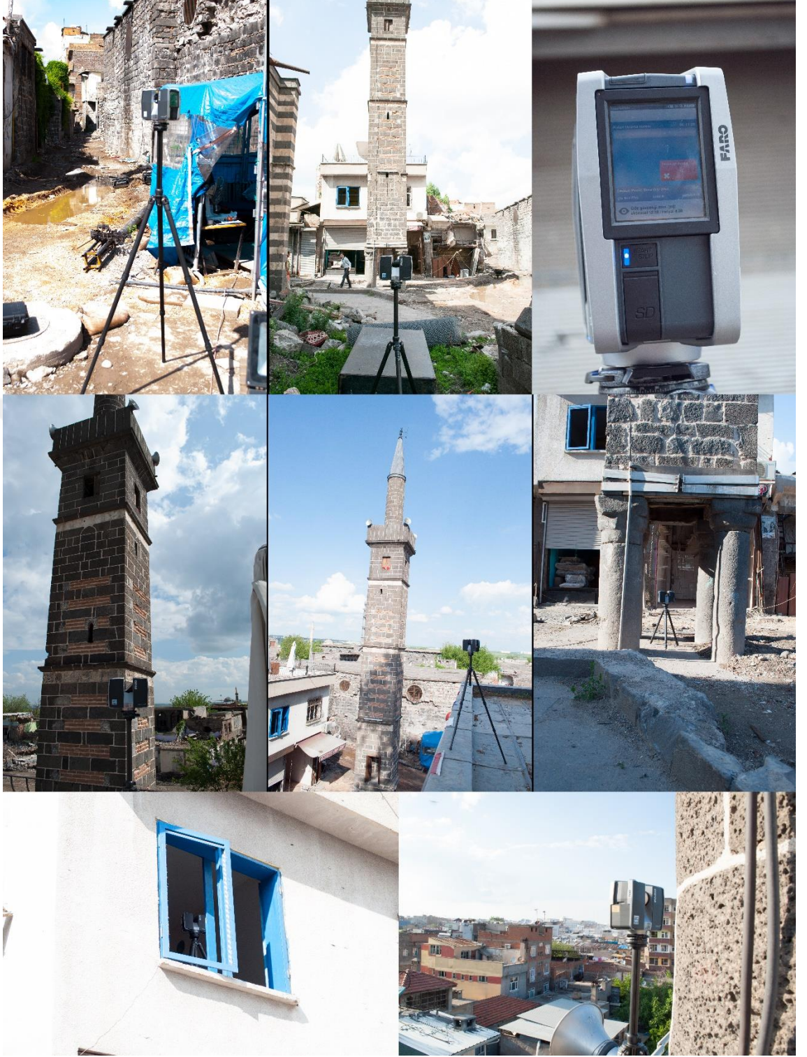
Şekil 4.10. FARO marka lazer tarayıcı ve bu cihazın tarama için yerleştirildiği bazı lokasyonlar.
