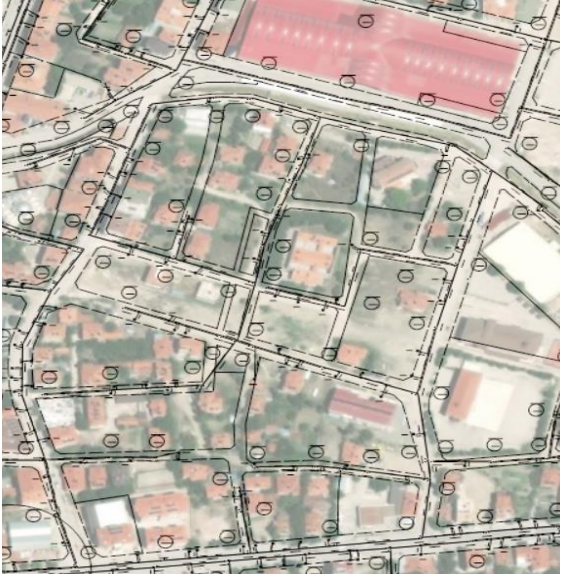
Şekil 8.8. Kanalizasyon hattı (planlı alan)
