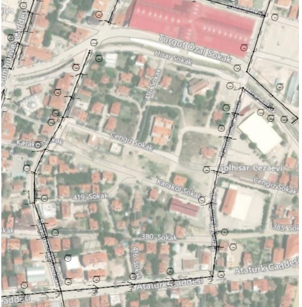
Şekil 8.9. Yağmur suyu hattı (planlı alan)
