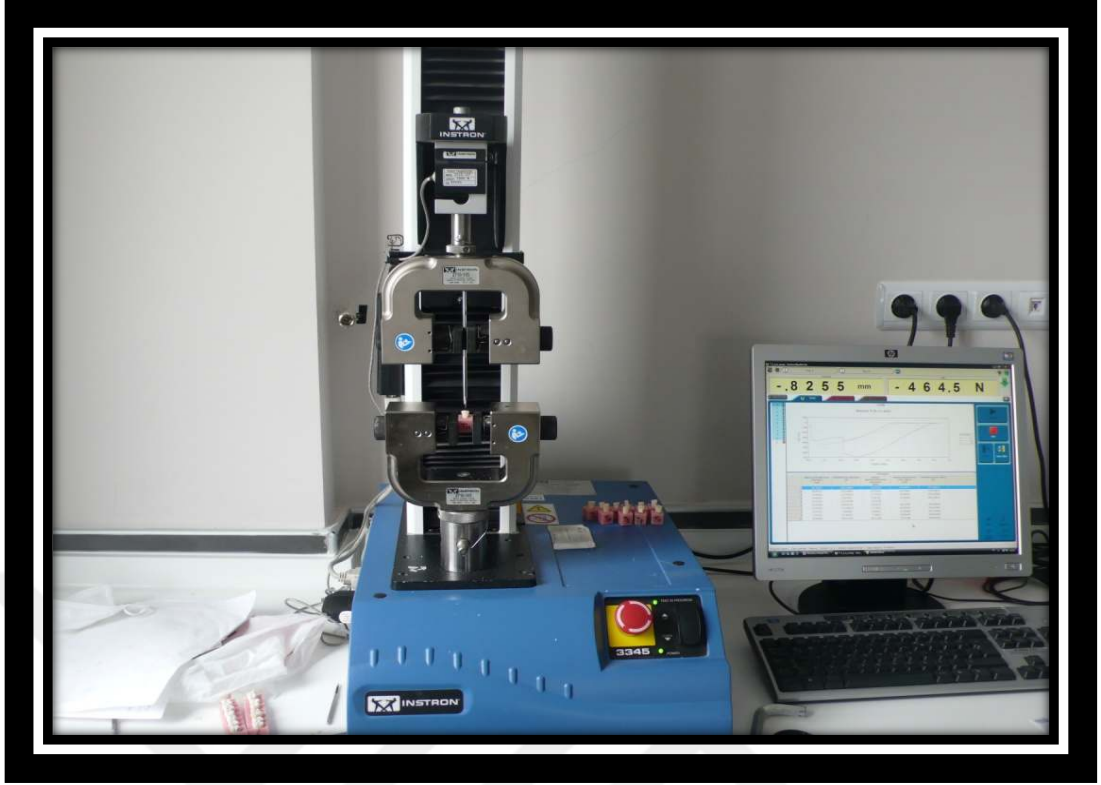
Resim 12: Örnek yerleştirilmiş Instron test cihazı ve bağlı olduğu bilgisayar.
