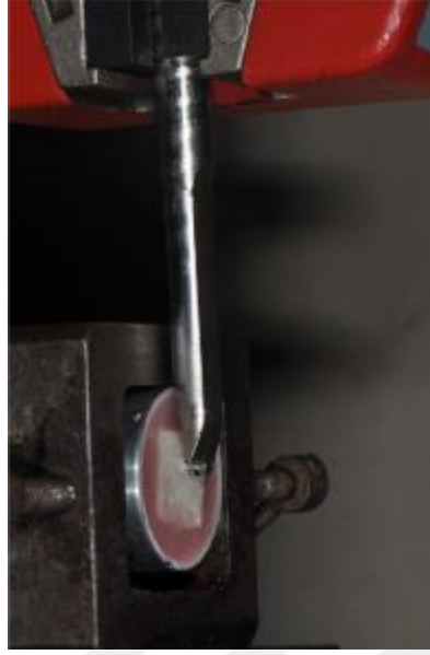
Şekil 3.15. 90° açı grubuna kuvvet direnci testinin uygulanması
