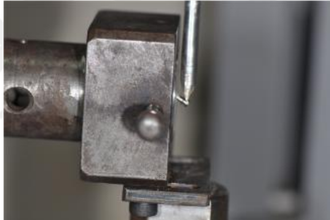
Şekil 3.16. 70° geniş açı grubuna kuvvet direnci testinin uygulanması
