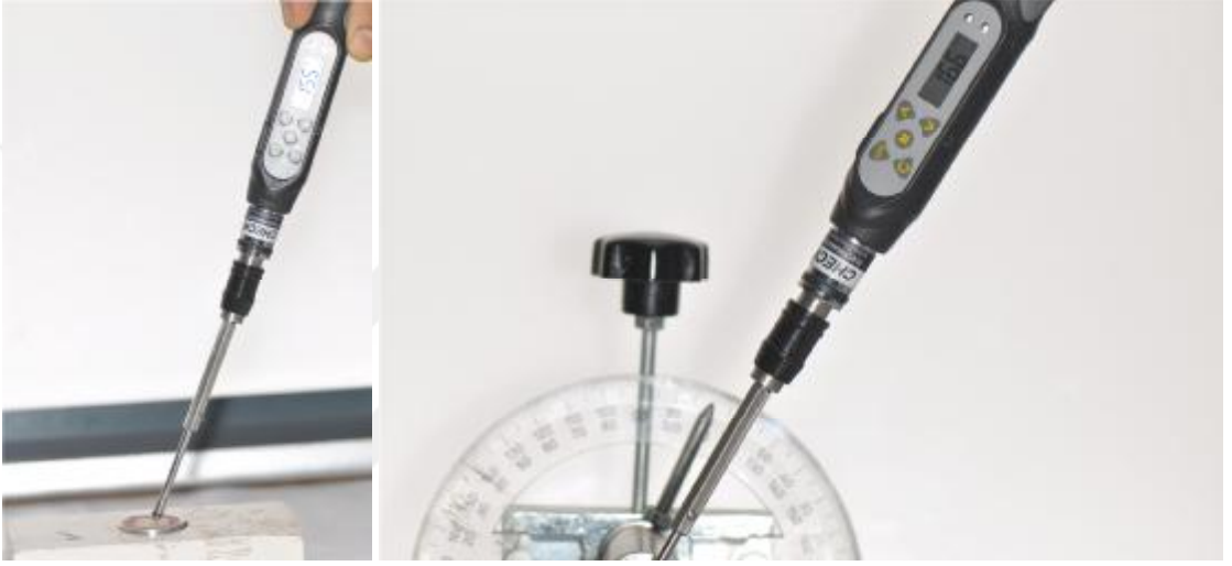
Şekil 3.12.a. Maksimum yerleştirme torkunun ölçülmesi (70° yerleştirme açısı)
