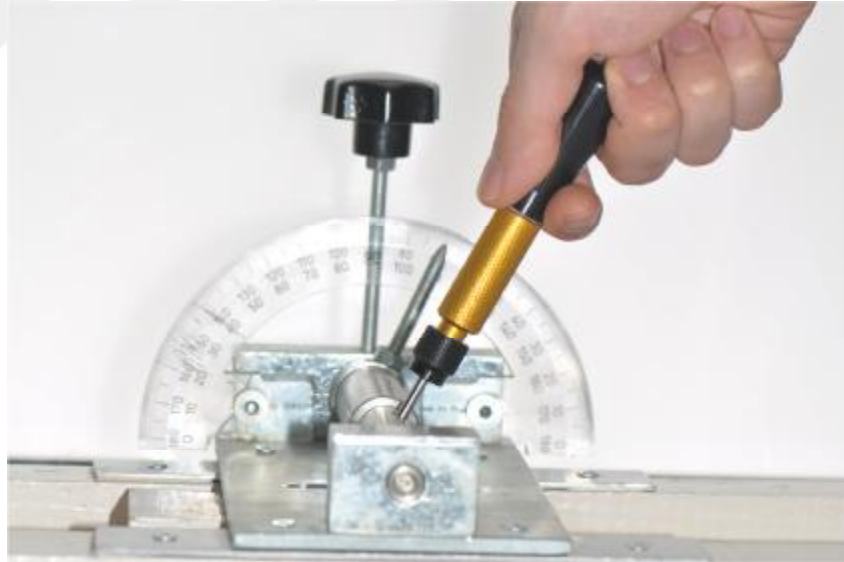
Şekil 3.11.b. Kemik bloklarına mini vidaların yerleştirilmesi
