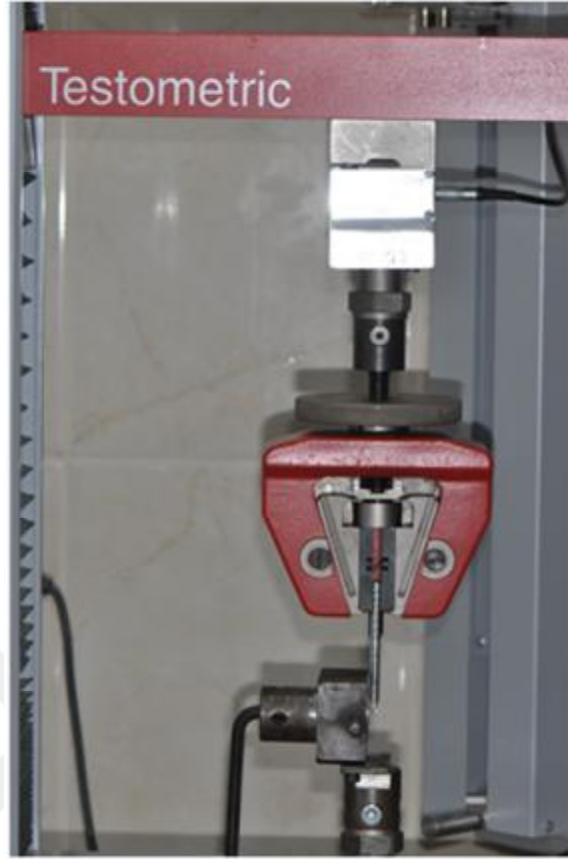
Şekil 3.13. Kuvvet direnci testinin uygulanması
