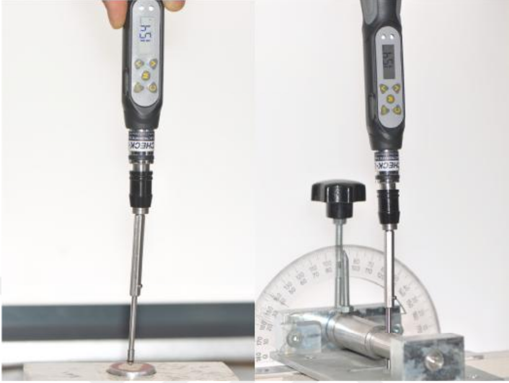
Şekil 3.12.b. Maksimum yerleştirme torkunun ölçülmesi (90° yerleştirme açısı)
