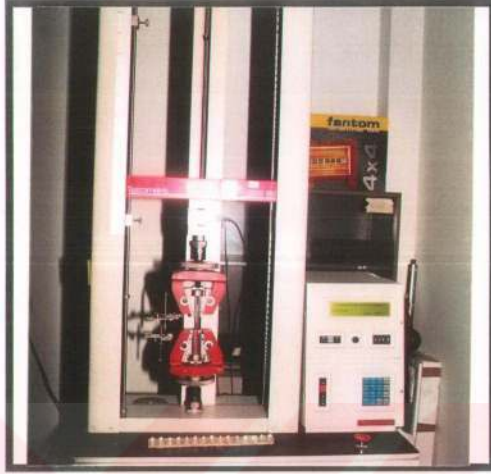
Resim 7: Kırılma dirençlerini ölçen, Testometrik mikro-500 markalı makine.
