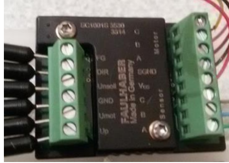
Şekil 2.9 : Hız kontrol ünitesi.
