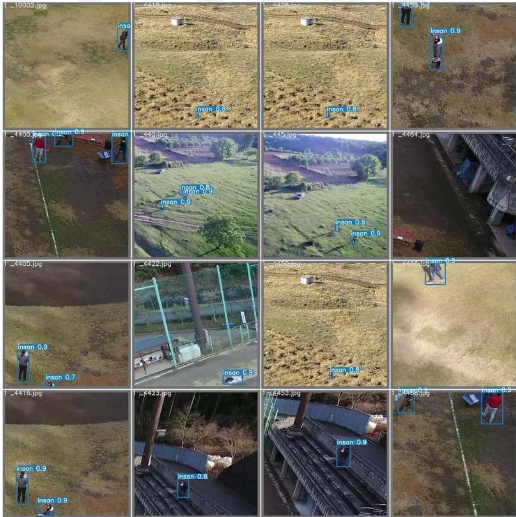
Şekil 3.12. Eğitilen modelin test görüntülerinden tespit örnekleri
