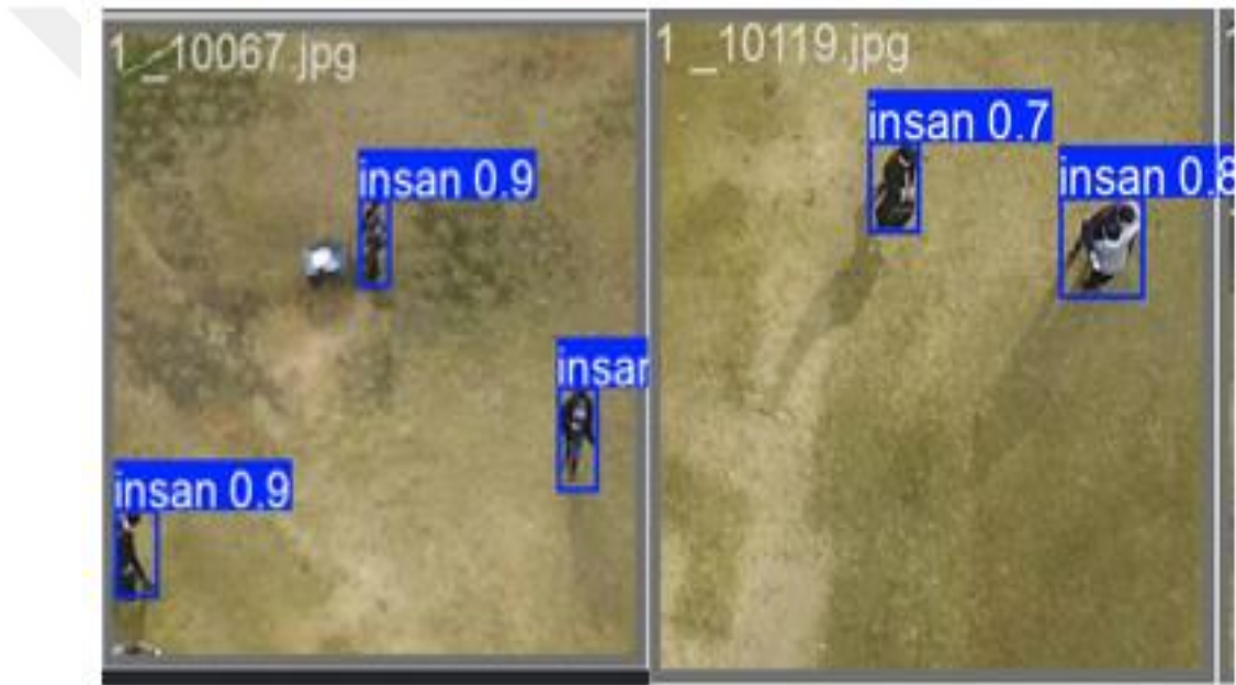
Şekil 3.24. Yolov10 modeline ait hatalı tespit örnekleri
