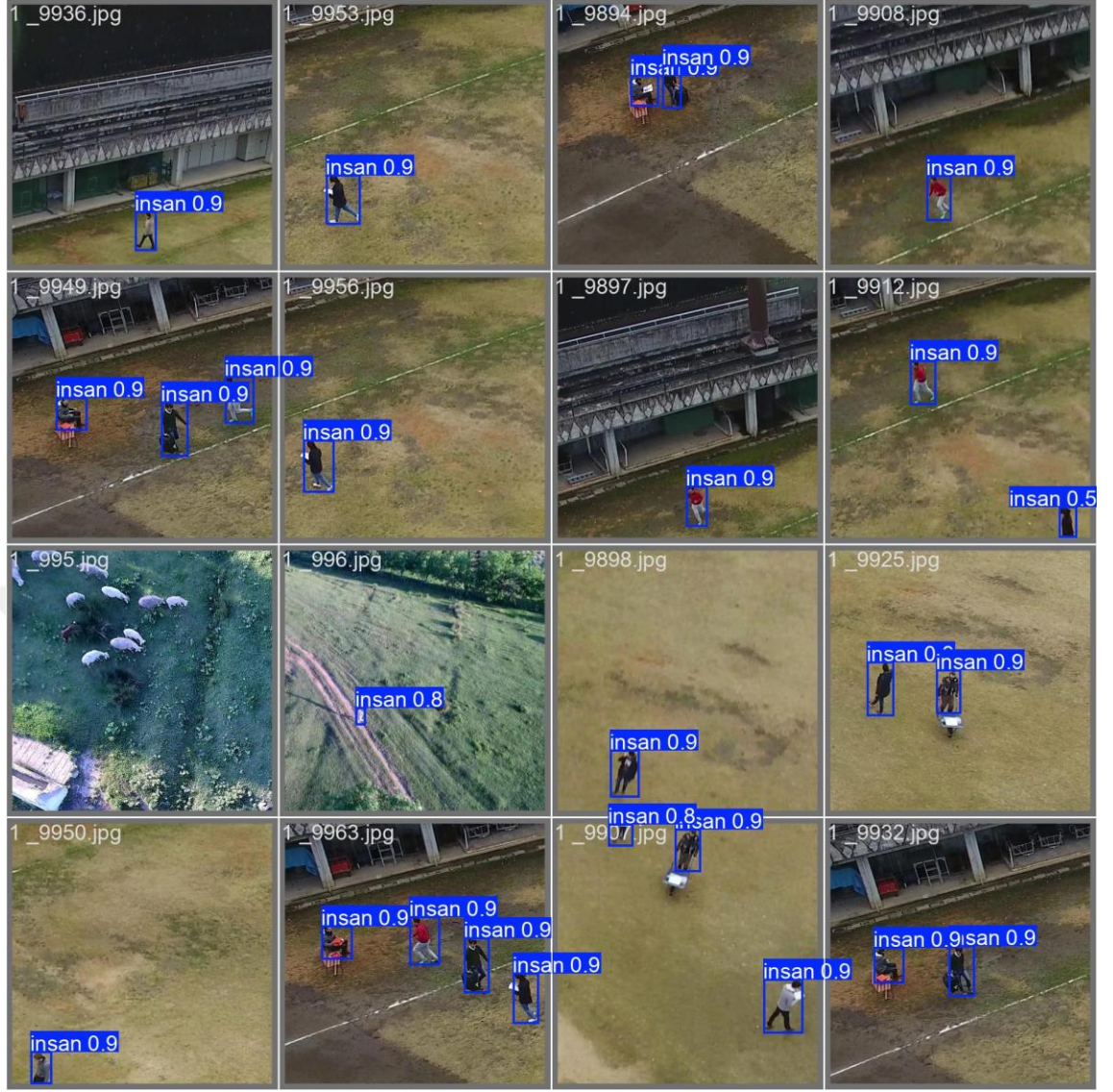
Şekil 3.22. Eğitilen modelin test görüntülerinden tespit örnekleri
