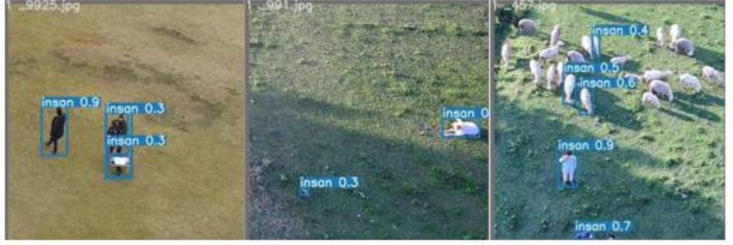
Şekil 3.14. Yolov7 modeline ait hatalı tespit örnekleri
