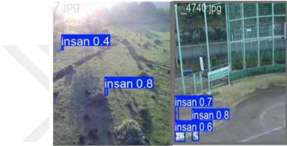
Şekil 3.19. Yolov8 modeline ait hatalı tespit örnekleri
