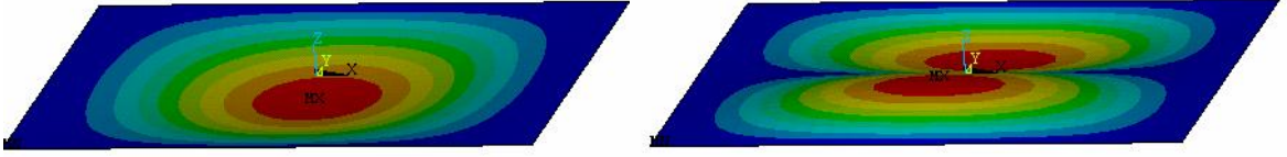
Şekil 3.6 Dört kenarı boyunca mesnetlenmiş plağın 1. SS modu ve 1. SA modu
