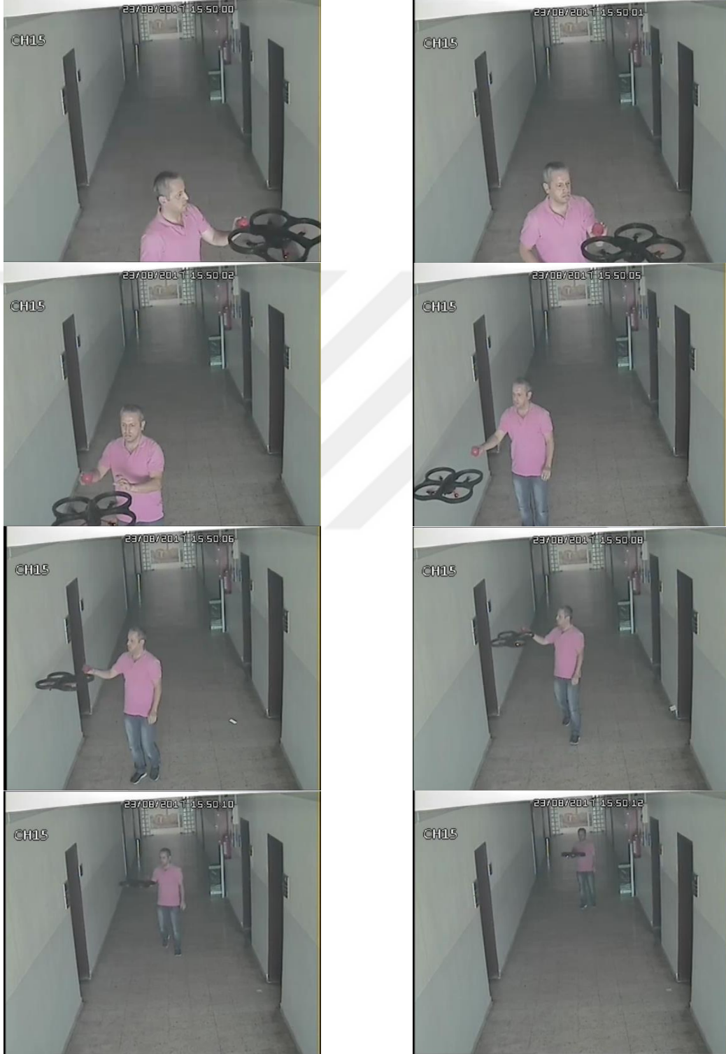
Şekil 6.34. Ar.Drone'nin EZ-Builder ortamında kırmızı renkli nesneyi takibine ait kamera görüntüleri
