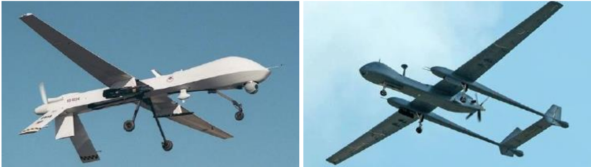
Şekil 1.2. Kaldırma kuvvetini kanatları vasıtasıyla sağlayan İHA'lar [6,7].
