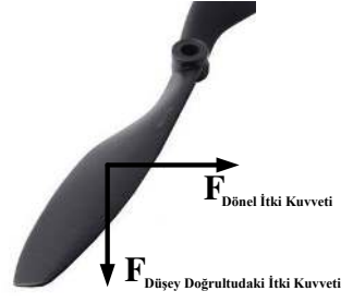
Şekil 3.1. Qaudrotorun pervanesindeki itki kuvvetleri [20].
