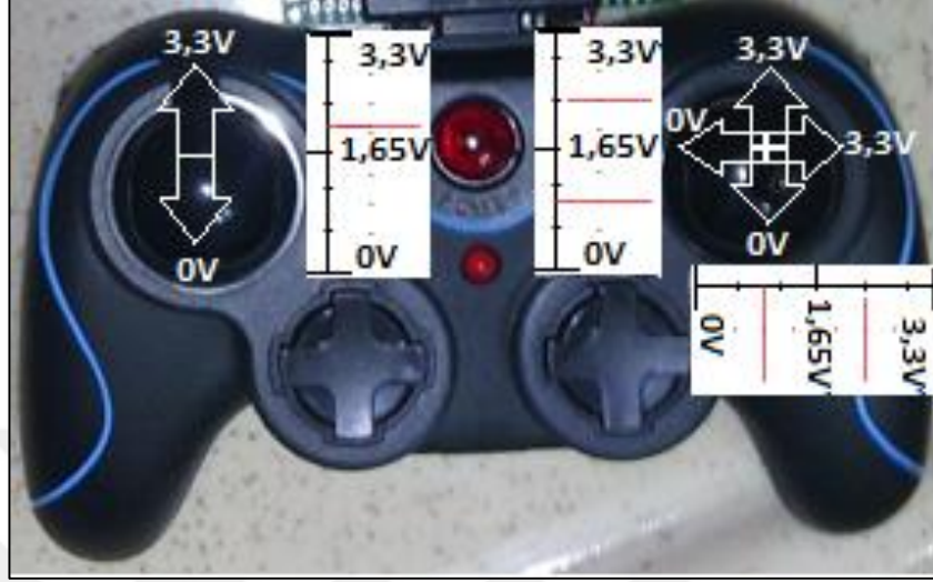
Şekil 5.30. Kumanda joysticklerinin konumlarına göre ürettiği gerilimler
