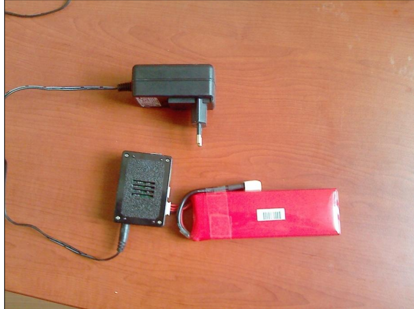
Şekil 4.16. Kullanılan Li-po Batarya Ve Şarj Cihazı
