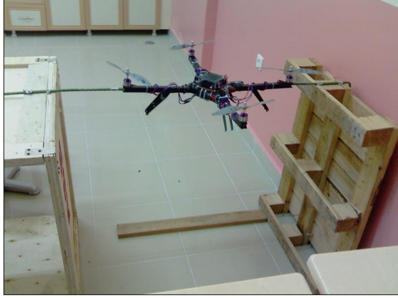
Şekil 6.2. Eksen Ayarları İçin Oluşturulan Test Düzeneği
