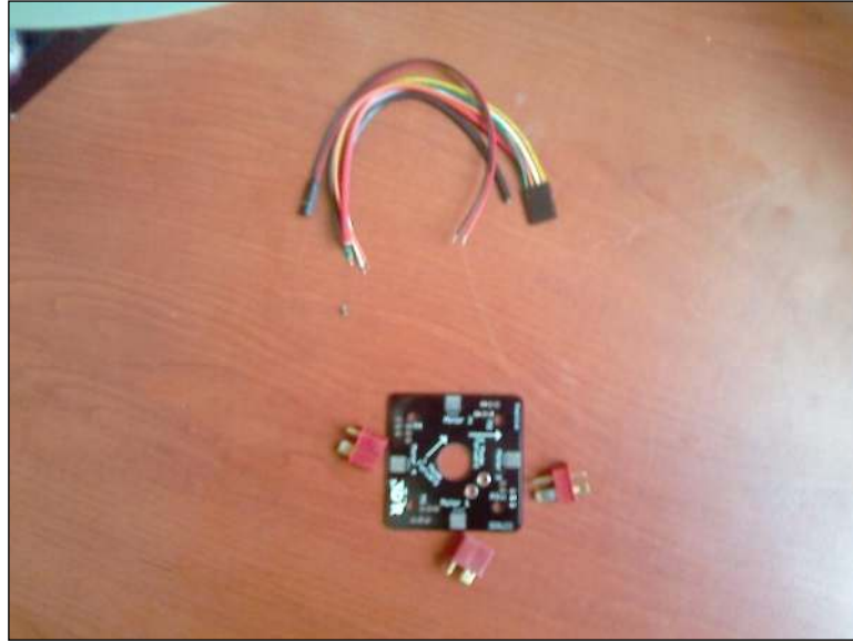
Şekil 4.17. Güç Dağıtım Bordu
