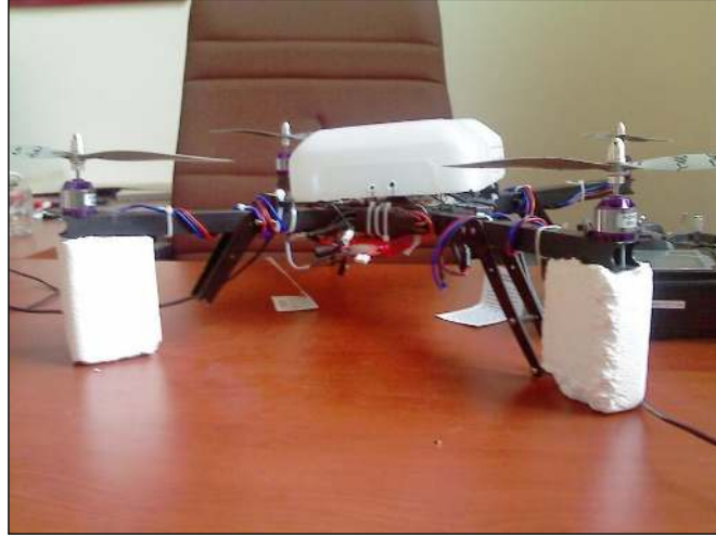
Şekil 6.3. Koruma Kapağı ve Darbe Emici Ayak Malzemeleri
