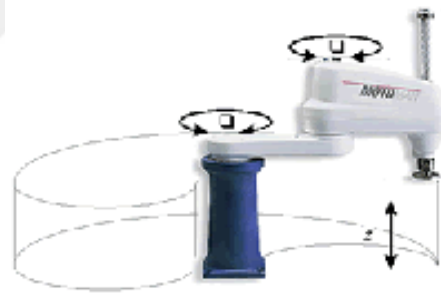
Şekil 2.7. Silindirik koordinat sistemine sahip robot
