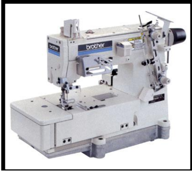
Resim 7.3. Tek iğneli zincir dikiř makinesi[29].
