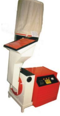
Resim 7.21. Sünger Kırpma Makinesi [30].
