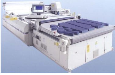
Resim 7.11. Cutter Seri Kumaş Kesim Makinesi Optimizasyon Görünümü [30].
