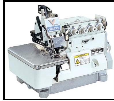
Resim 7.2.    iplikli overlok makinesi[29].
