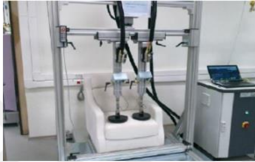
Resim 2.9.d. Oturma Yeri ön kenarı yorulma deneyi (Çiftçi ve ark., 2015).
