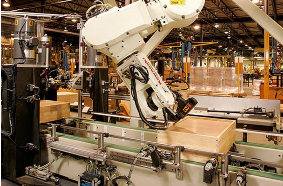
Resim 2.6. İskelet montajlarının yapıldığı otomasyon sistemi (URL - 29).
