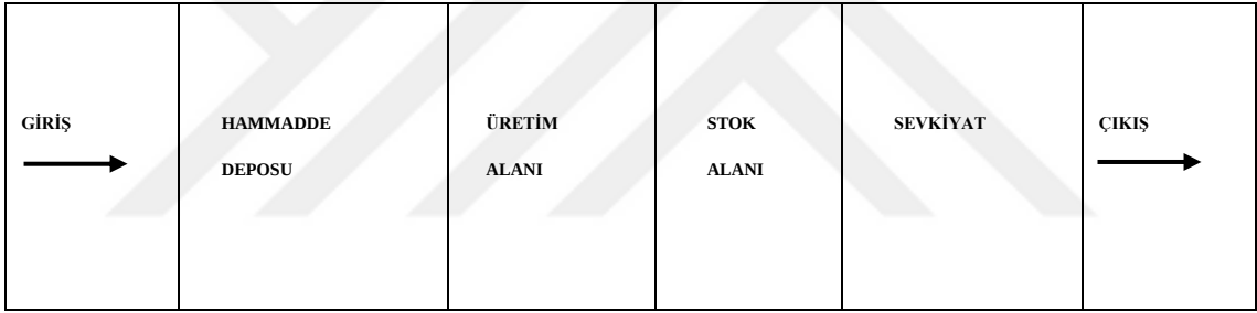
Şekil 3.8. Üretim tesisi ana binası plan taslağı
