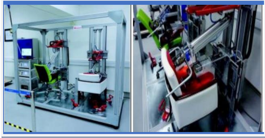
Resim 2.9.a. Döşemeli mobilya test cihazı (Çiftçi ve ark., 2015).
