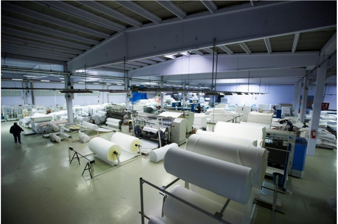
Resim 4.9. Mondi Mobilya üretim tesisi epoksi zemin (Mondihome fotoğraf arşivi)
