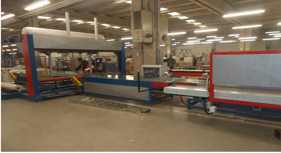
Resim 2.10.a. İstikbal Mobilya koltuk –kanepe, yatak – baza ambalajlama makineleri
