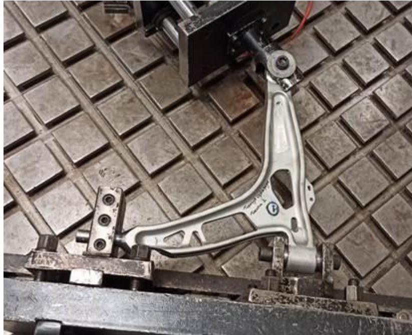
Şekil 7.10. 2.Tasarım Salıncak Kolunun Rijit Tablaya Montajı
