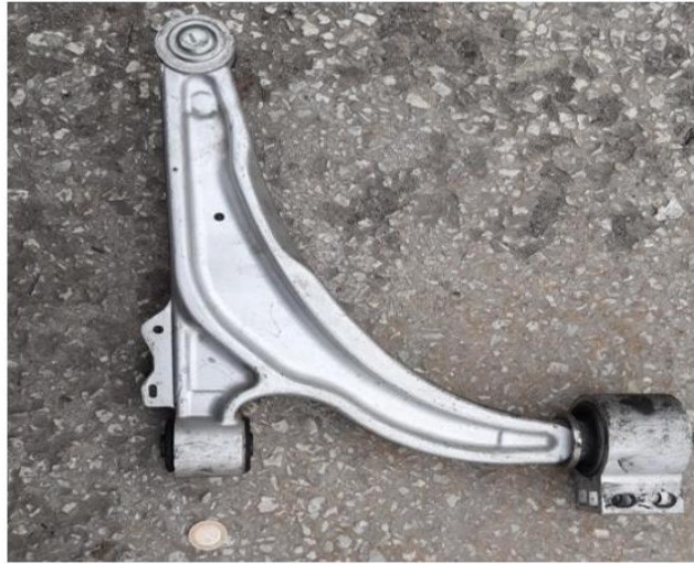
Şekil 3.2. Alüminyum dövme salıncak kolu [1]
