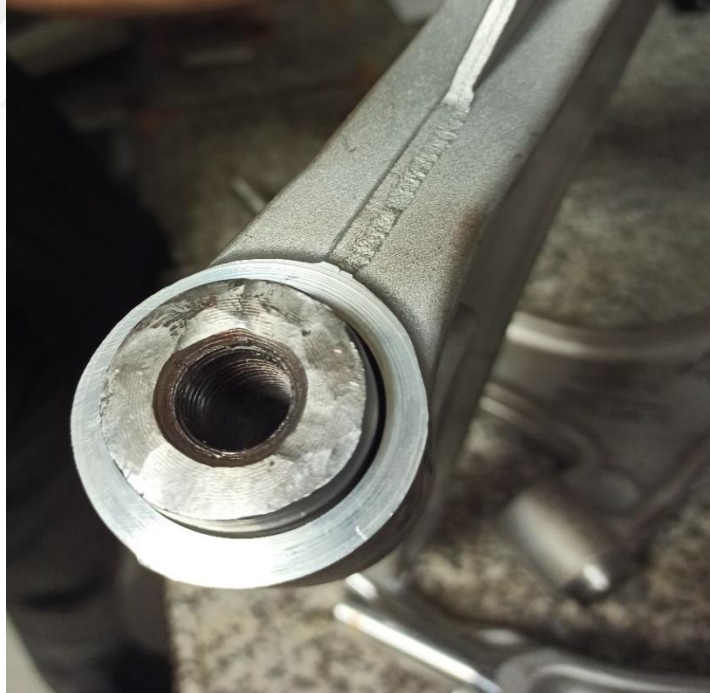
Şekil 7.8. Fixed Support Bağlantı M16 Burcu
