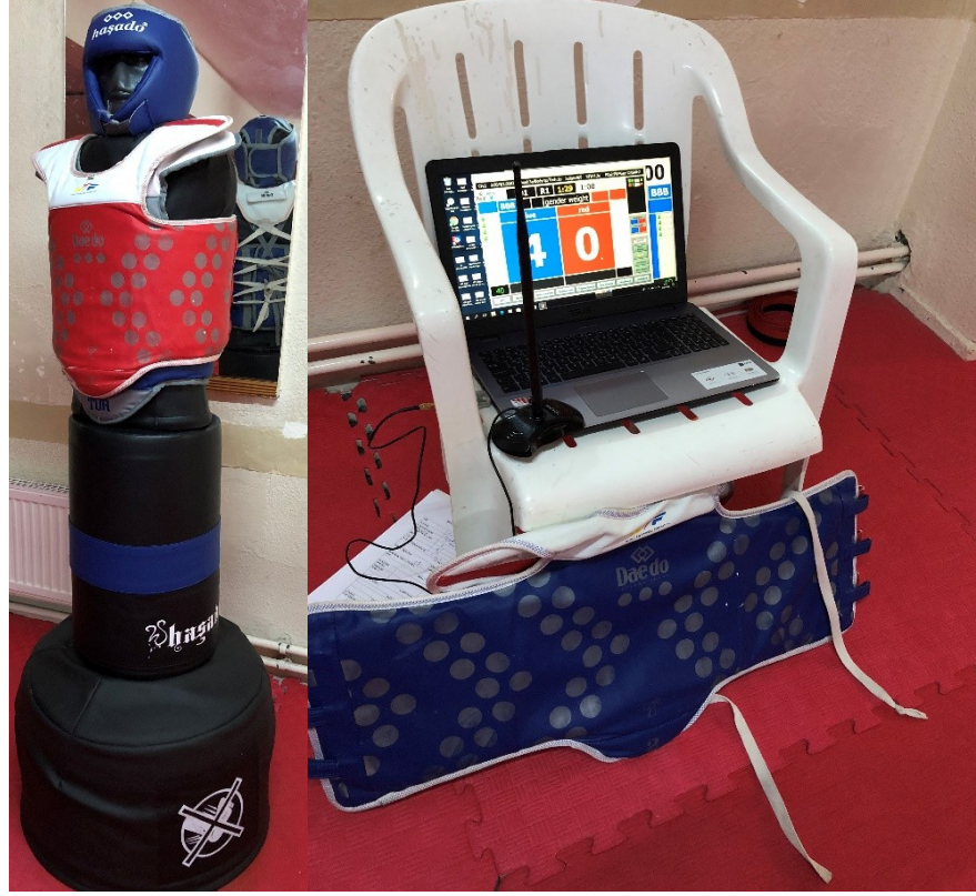
Resim 3.6: Truescore Daedo 2014 Elektronik Vücut Koruyucu Sistemi
