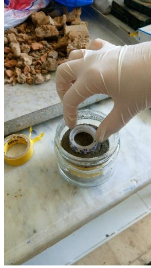
Şekil 3.14. Zemin numunesinin kavanoz içine yerleştirilmesi
