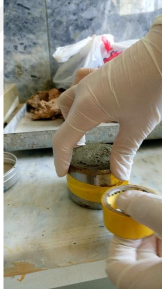
Şekil 3.13. Zemin numuneleri birleştirilerek etraflarının izole bantla sarılması
