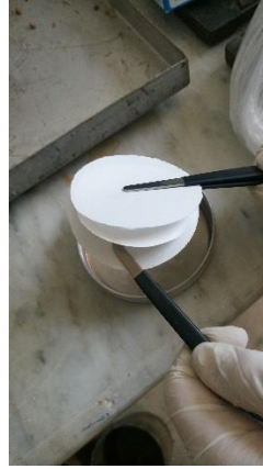
Şekil 3.11. Kullanılan filtre kağıtlarının konumlandırılması
