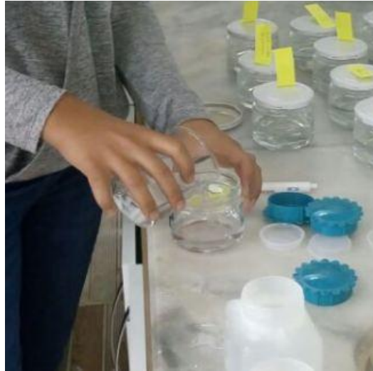
Şekil 3.5. Kavanozlara NaCl çözeltilerinin doldurulması
