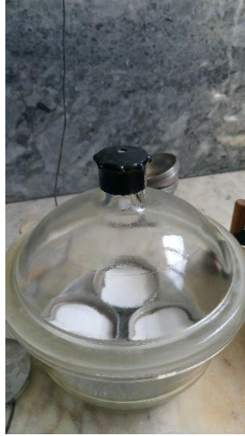
Şekil 3.10. Filtre kağıtlarının desikatör içinde bekletilmesi
