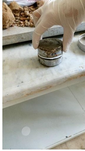
Şekil 3.12. Zemin tabakaları arasına filtre kağıdının yerleştirilmesi
