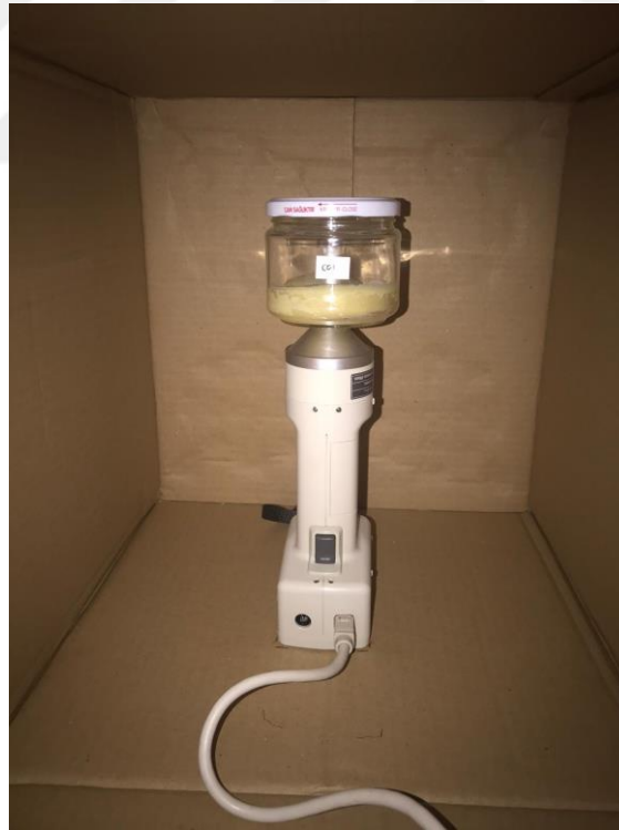
Şekil 3.8. Oleojel örneklerinde renk ölçümü
