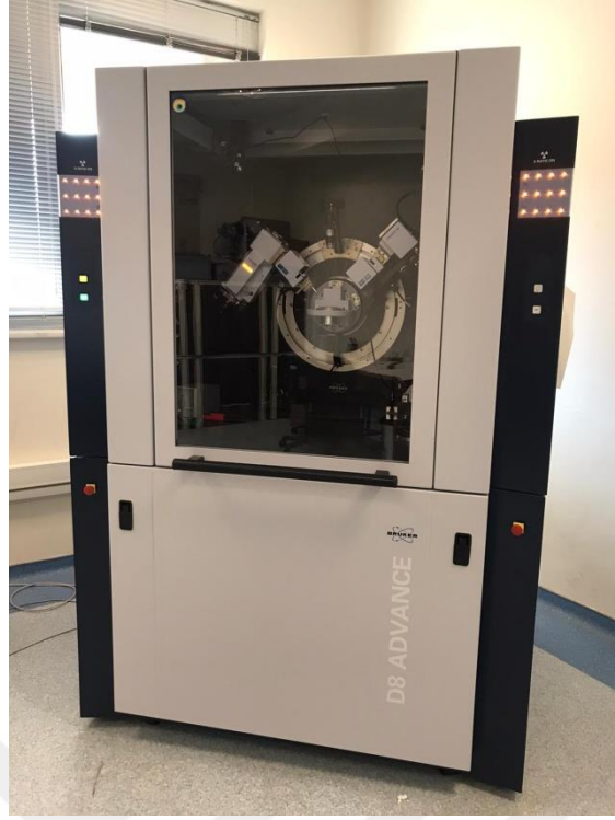
Şekil 3.11. Çalışmada kullanılan XRD cihazı
