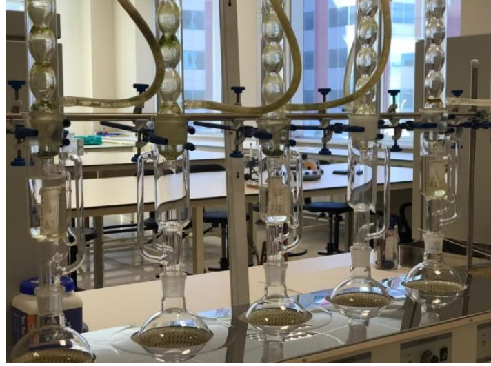
Şekil 3.14. Çalışmada kullanılan Soxhlet cihazı
