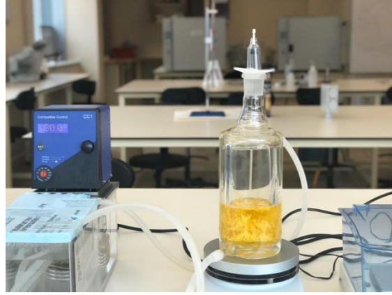
Şekil 3.2. Oleojel yapımında kullanılan çift cidarlı cam reaktör
