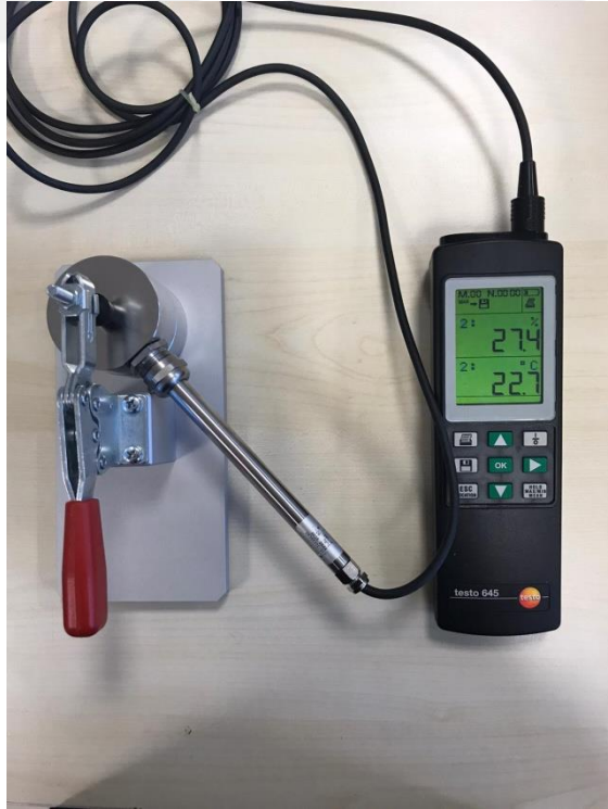
Şekil 3.13. Çalışmada kullanılan su aktivite cihazı
