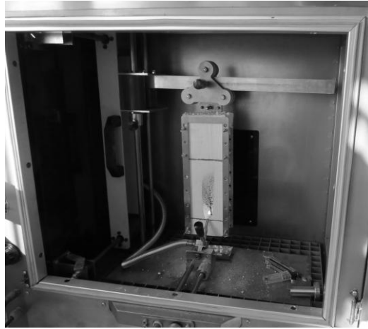
Resim 4.3 Yalıtım levhalarında tutuşma deneyi.
