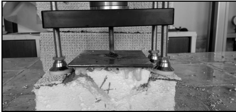
Resim 5.5 Yapışma testinde mantolama levhalarında görülen deformasyon.
