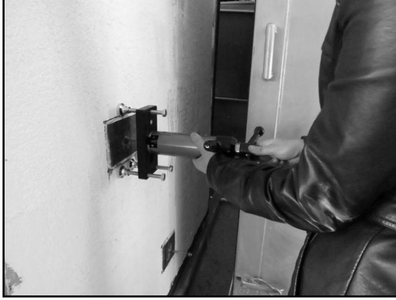
Resim 5.6 Düşey düzlemde sıva yapışma deneyi.
