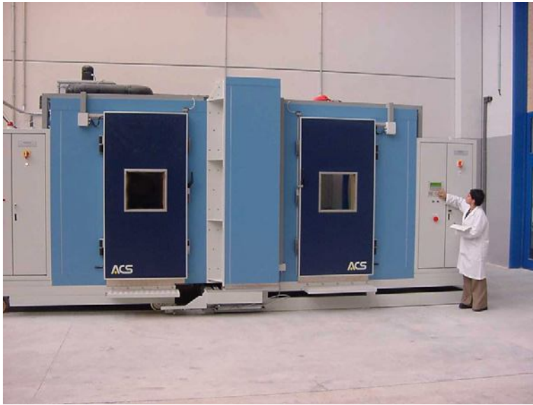
Resim 2.4. Sala vd. tarafından kullanılan sıcak kutu deney cihazının görünümü [66]
