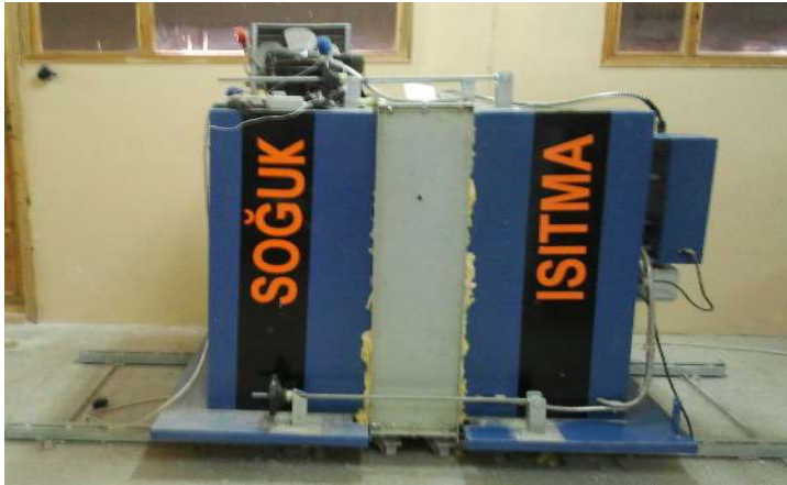
Resim 3.3. Deneysel çalışmada kullanılan sıcak kutu deney cihazı
