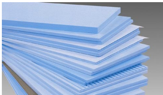
Resim 3.2. Deney duvarlarının ısı yalıtımında kullanılan XPS ve EPS levhaları
