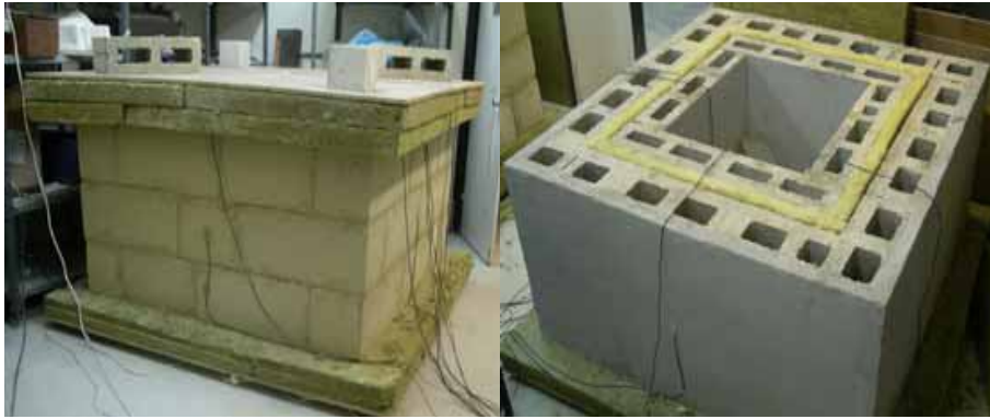
Resim 2.3. Abela'nın deneylerde kullandığı sıcak kutu deney cihazı [62]
