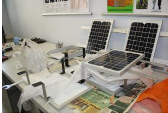
Şekil 5.5 : Kullanılan Z tipi ve I tipi metal bileşenler ile panellerin laboratuvar ortamında birleşimleri.
