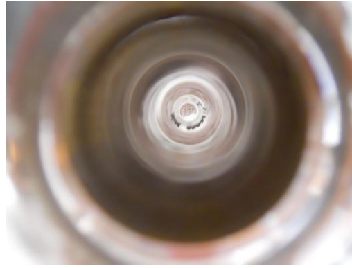
Şekil 4.25. Kolon duvarına tutunan manyetit topakların üstten görünüşü (I = 3 Amper)
