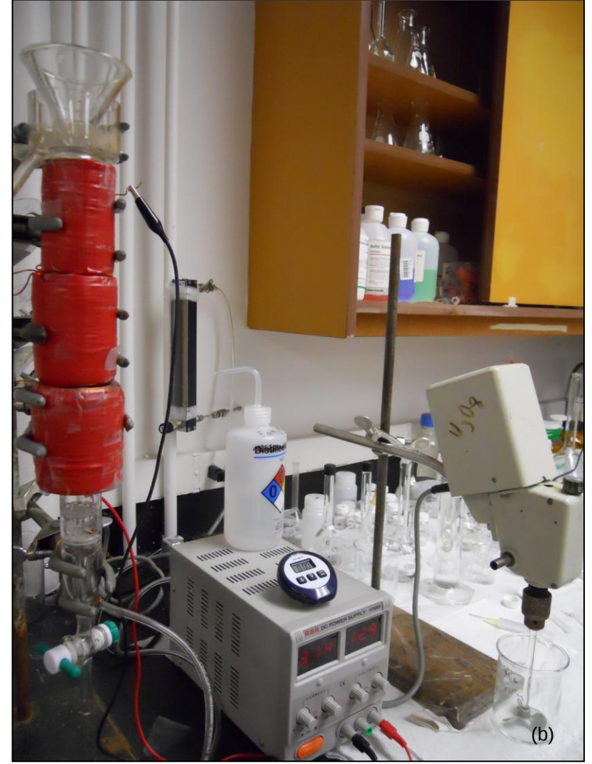
b) Manyetik flotasyon deney düzeneği ve yardımcı ekipmanlar
