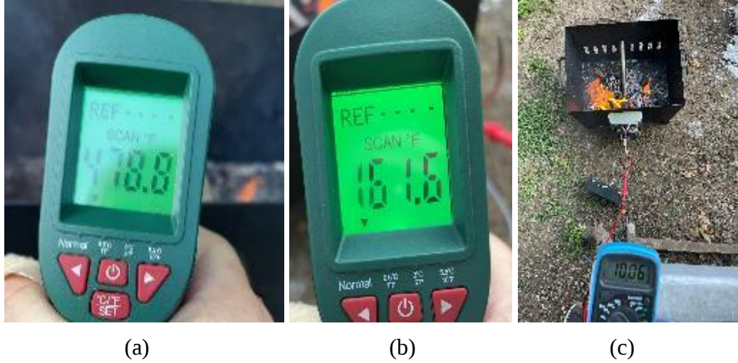
Şekil 5.10. Pişirme ünitesi ağaç yakıtlı test iç hazne °F sıcaklığı (a), TEG ünitesi ısı emiş haznesi ağaç yakıtlı test °F sıcaklığı (b), ağaç yakıtlı test sonucu elde edilen yüksüz voltaj değeri (c).
