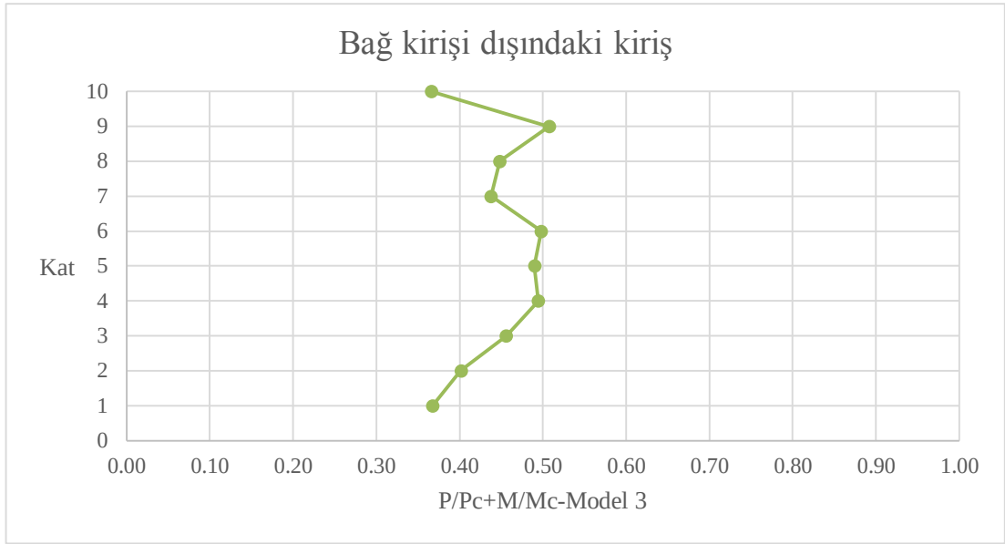
Şekil 6.30 : Model 3 bağ kirişleri dışında kalan kiriş parçaları için istem/kapasite oranları.
