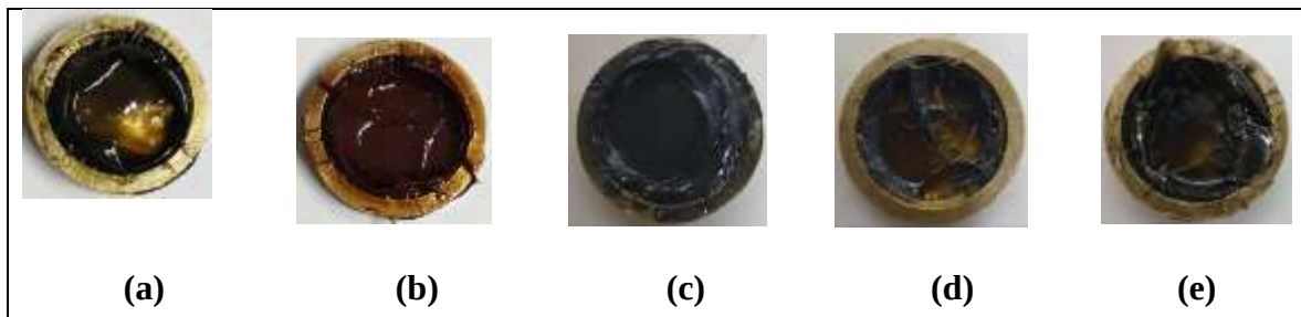
Resim 3.9. Isı deneylerinden sonra Gres 2 numuneleri, (a) katkısız, (b) CuO, (c) Grafit, (d) TiO 2 ve (e) ZnO katkılı
