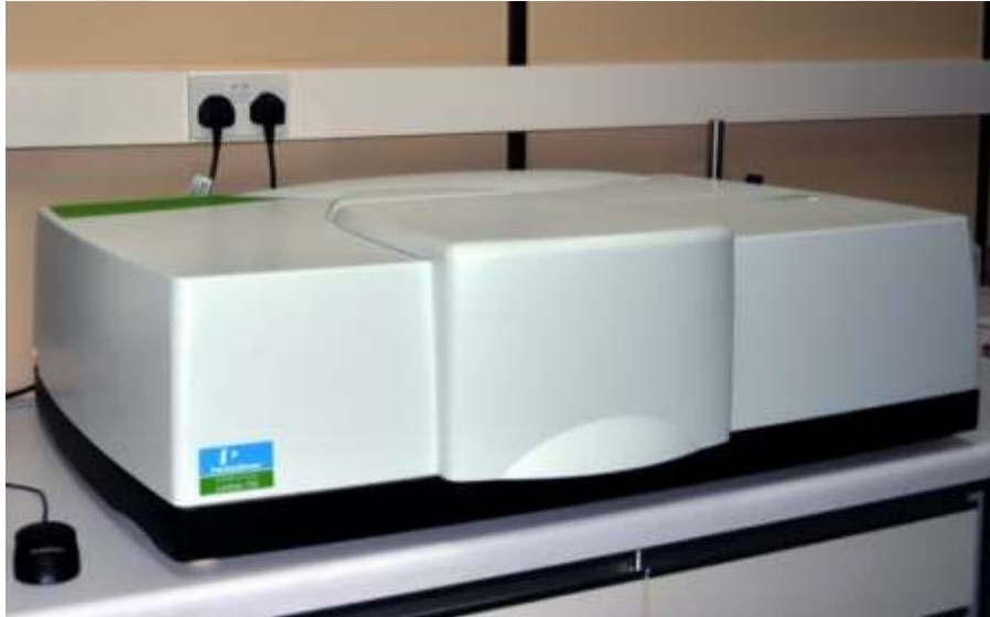
Resim 3.1. Görünür dalga boyunda soğurma değeri ölçümünde kullanılan cihaz
