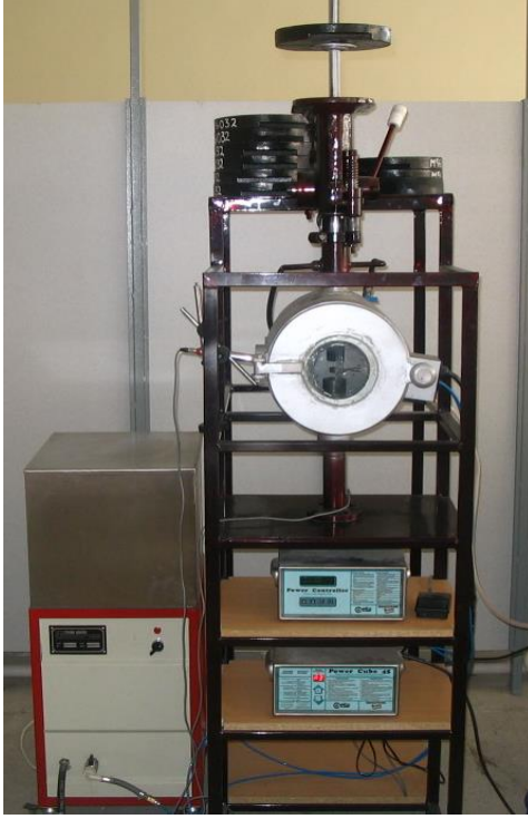
Şekil 3.2. Difüzyon kaynak düzeneğinin şematik görüntüsü [54].
