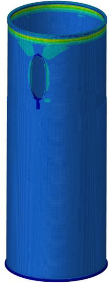
Şekil 12-10: HyperWorks programında statik analiz işlemi gerçekleştirilen kule alt bölümü (Tower Transition Section) Von Mises stress değerleri .
