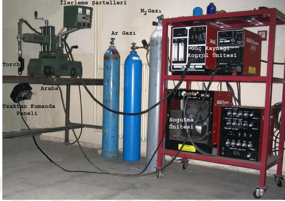
Şekil 5.5. Thermal Dynamic/Ark Plazma Transfer Ark (PTA) kaynak makinesinin tüp bağlantıları ve kontrol panosu
