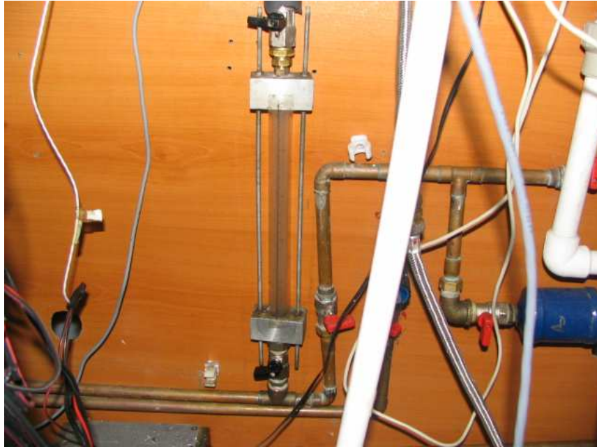
Şekil 4.15 Yoğuşan R134a'nın debisinin süre tutularak ölçüldüğü ölçekli cam tüp
