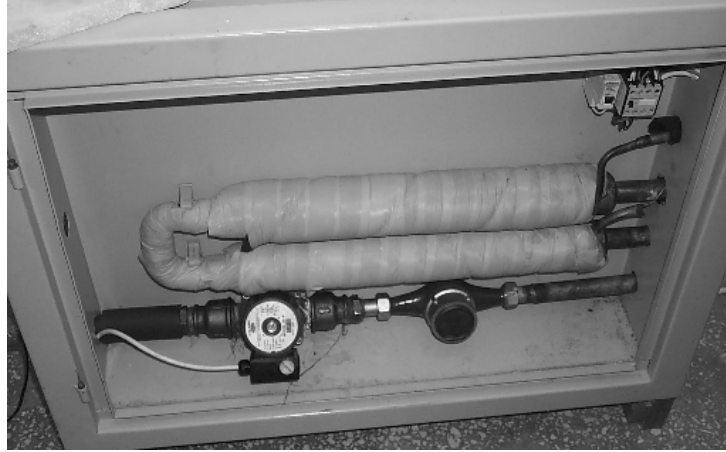
Şekil 5.2. Su-antifiriz karışımının debisini ölçmek için kullanılan su saatinin görüntüsü
