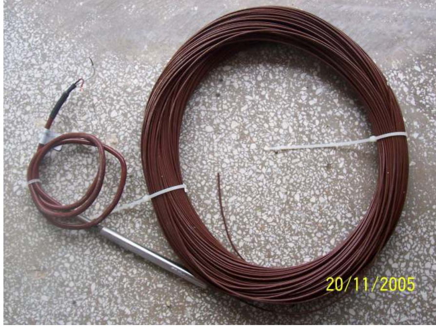
Şekil 3.19. Toprağa yerleştirilen ısıtıcı problemlerin görünümü
