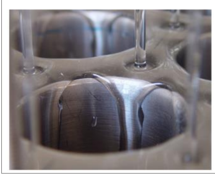
Resim 2.1. Dağıtım deliklerden aktarılan sıvının ısıtma tüplerine girişi [3]
