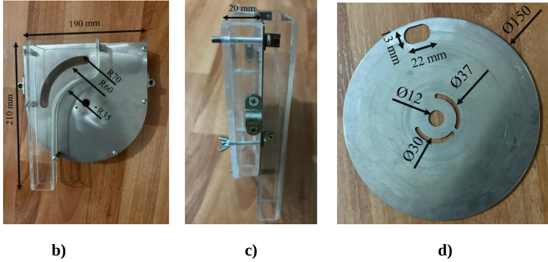
Şekil 3.2. Laboratuvar tipi ekici düzen. a) genel görünüş, b) ön görünüş, c) yan görünüş, d) tohum düşme noktası ayar plakası
