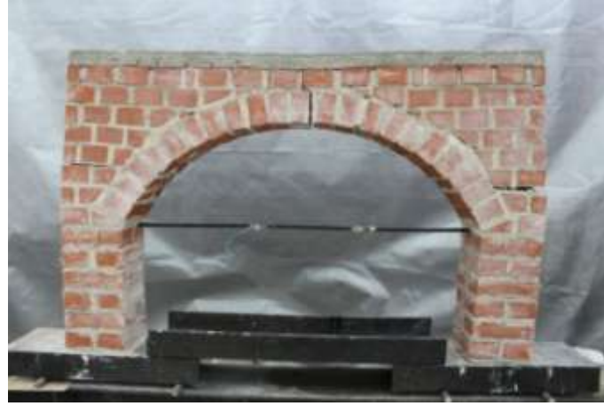
řekil 3.17: Model-1 deney numunesinin gme sonucundaki hali.
