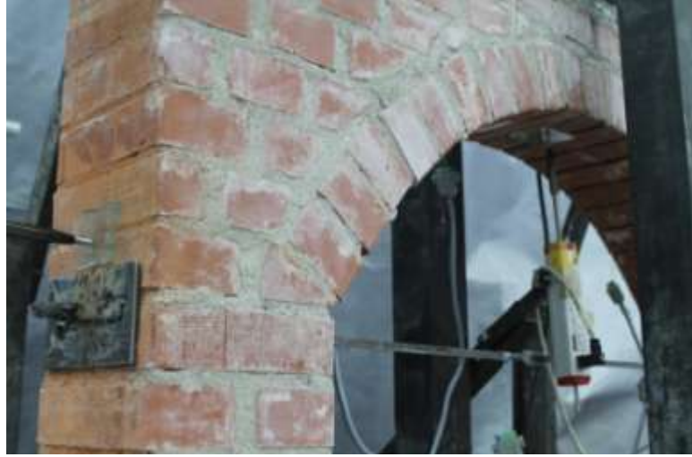
Şekil 3.29: Model-4 olarak isimlendirilen gergi çubuğu sistemi.
