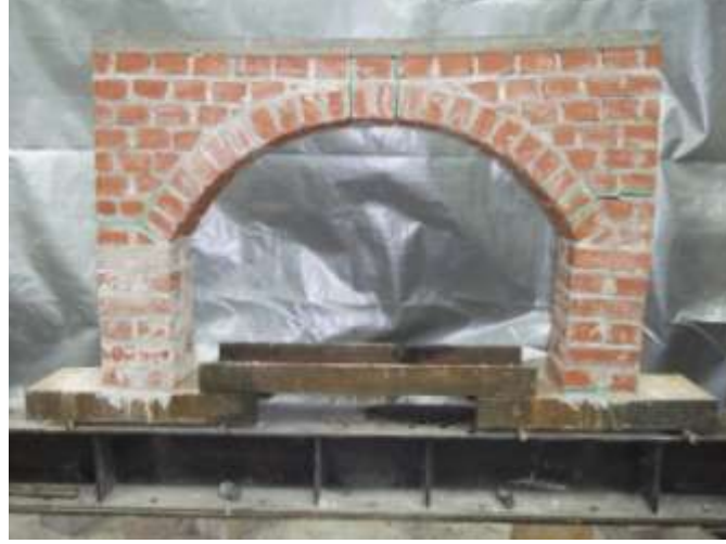
Şekil 3.12: Kontrol deney elemanının göçme sonucundaki hali.
