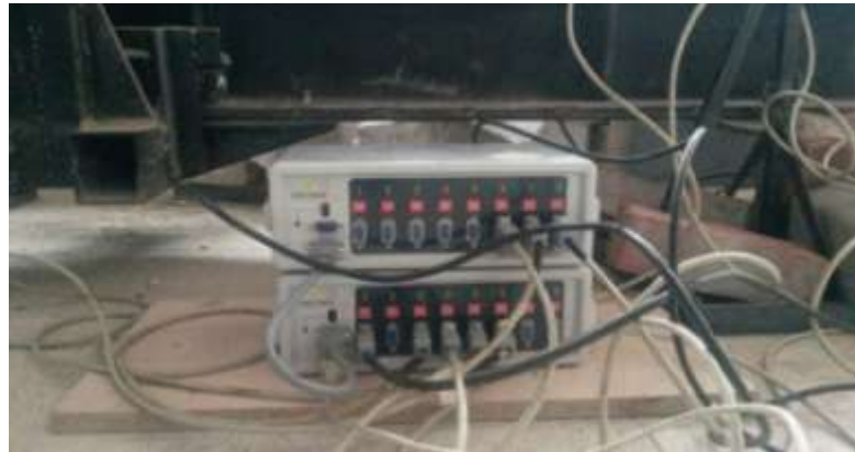
Şekil 3.6: Deney düzeneęindeki yük hücresinin, strain-gaugelerin ve LVDT'lerin veri toplama ünitesine bağlanması.
