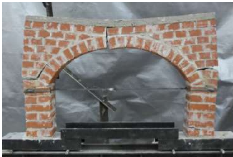
Şekil 3.22: Model-2 deney numunesinin göçme sonucundaki hali.
