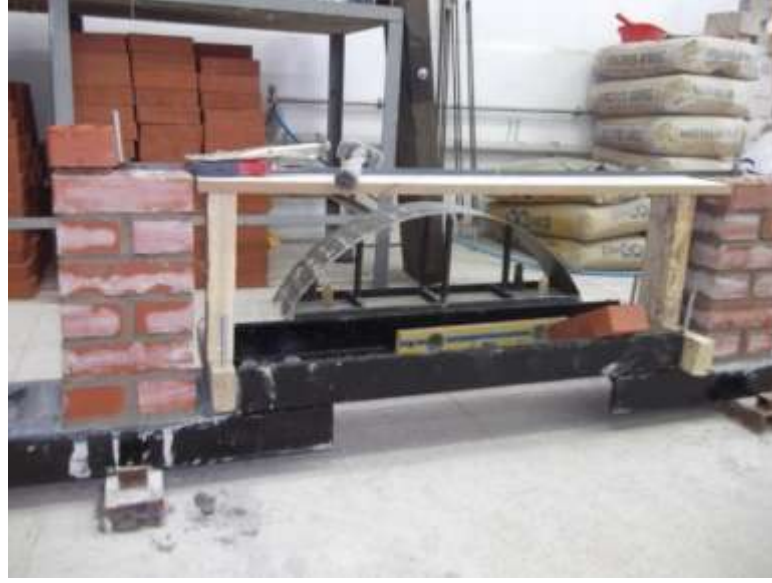
Şekil 3.8: Kemer örümünde kullanılan kemer kalıbı.
