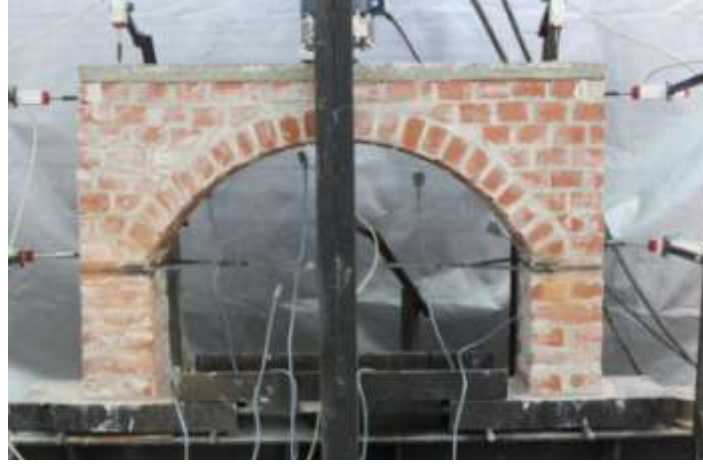
Şekil 3.25: Model-3 deney numunesinin görünümü.
