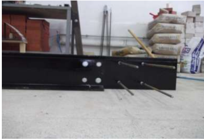
Şekil 3.1: Kemerin oturtulduğu kolonların altındaki U220 profili üzerinde açılan delikler.
