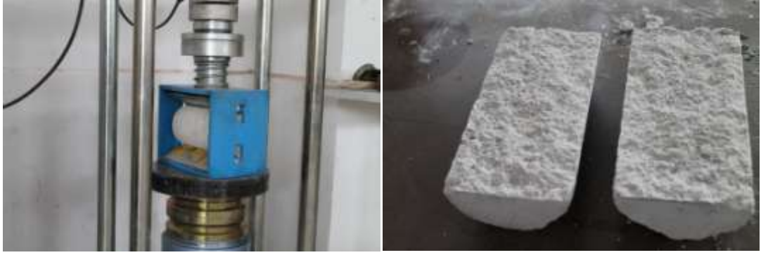
Şekil 2.4: Harcın çekme dayanımı testi.
