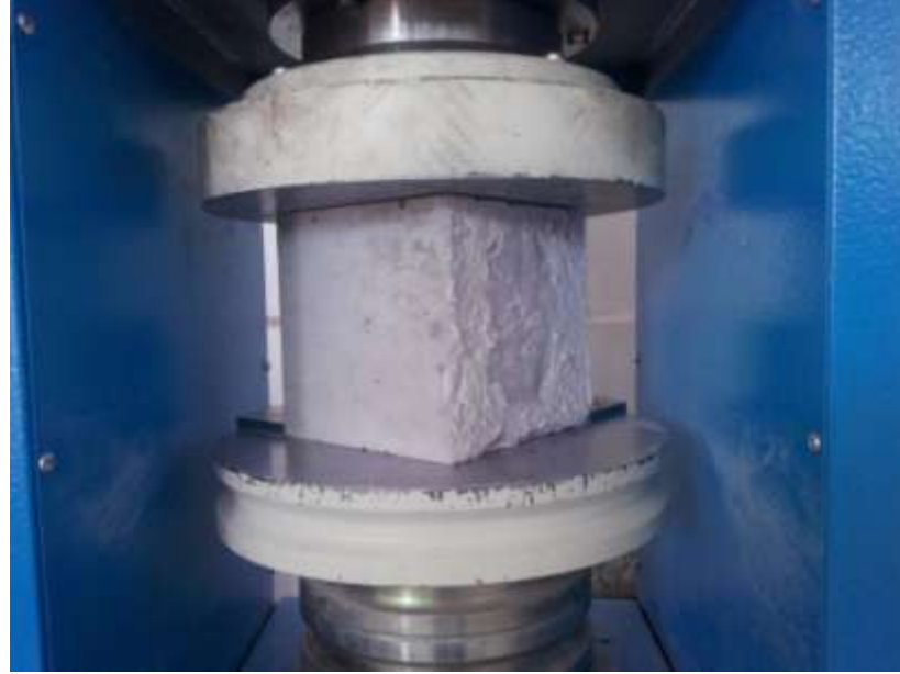
Şekil 2.3: Harcın basınç dayanımı testi.
