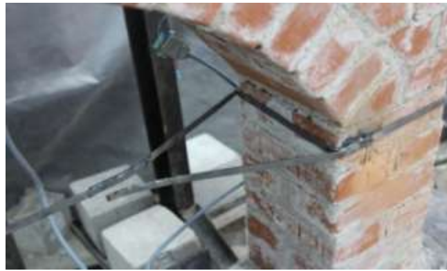
Şekil 3.26: Model-3 deney sonrasında gergideki kaynağın açılmış hali.
