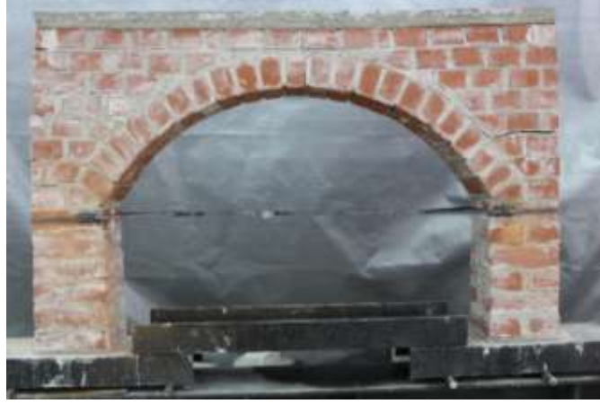
Şekil 3.27: Model-3 deney numunesinin göçme sonucundaki hali.
