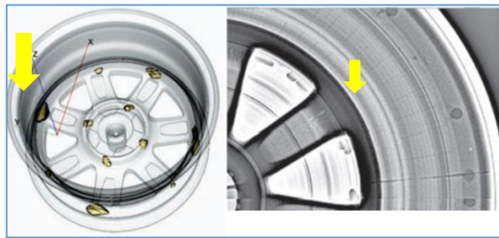
Şekil 3.18. Jant üzerinde hata riski bölgeleri ve röntgen filminde gerçek hata pozisyonları [33].
