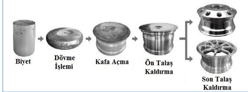
Şekil 2.3. Dövme ile jant üretimi işlem basamakları.
