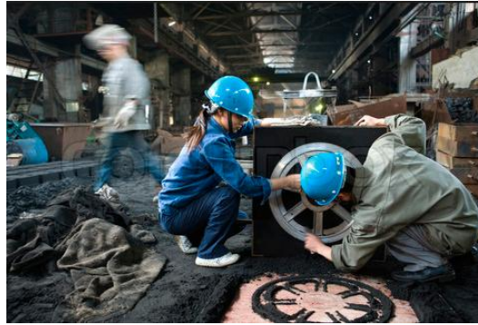
Şekil 2.4. Kum kalıba döküm yöntemi ile jant üretimi.
