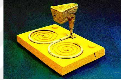
Şekil 4.5. Double-spiral akışkanlık testi sematik gösterimleri[39].
