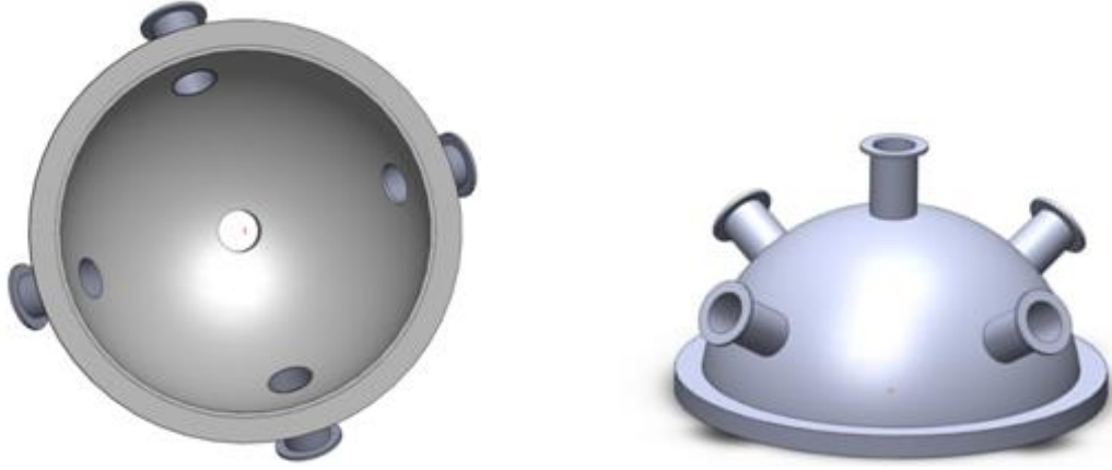
Şekil 1.3. Vakum odacığının farklı açılardan görüntüsü
